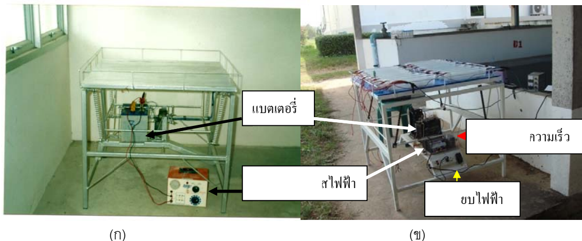
รูปที่ 2 โต๊ะขยับสารละลาย: (ก) โต๊ะที่จดอนุสิทธิบัตรหมายเลข (5254) ในปี 2546 และ (ข) โต๊ะที่พัฒนาให้มีความสะดวกในการใช้งานมากขึ้น
