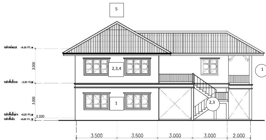
รูปที่ 6.8 รูปด้านแสดงข้อได้เปรียบและข้อจำกัดของ บ้านปูนสองชั้น
