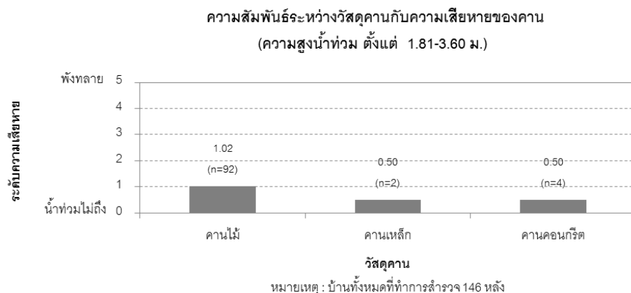
รูปที่ ข.38 ความสัมพันธ์ระหว่างวัสดุคานกับความเสียหายของคาน (ความสูงน้ำท่วม ตั้งแต่ 1.81-3.60 เมตร)
