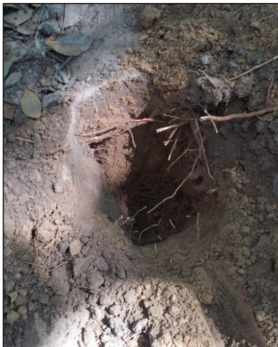
หลุมดินที่ขุดลึกลงไป 30 เซนติเมตร เพื่อเก็บตัวอย่างดิน
