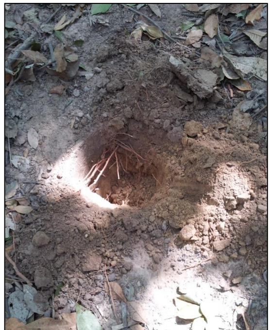
หลุมดินที่ขุดลึกลงไป 30 เซนติเมตร เพื่อเก็บตัวอย่างดิน
