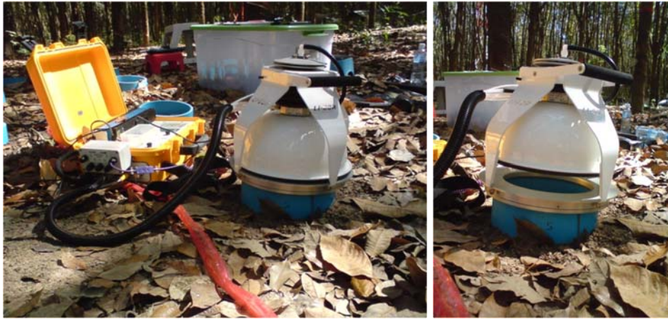
รูปที่ 2-24 เครื่องวัดอัตราการหายใจของดิน (Soil CO 2 Flux System) รุ่น LI-8100 ® (LI-COR, Inc., Ltd., U.S.A.)
