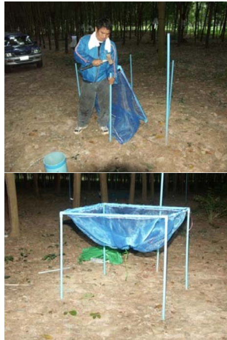
รูปที่ 2-34 การติดตั้ง Litter trap ในแปลงทดลองยางพาราที่ศูนย์วิจัยยางฉะเชิงเทรา
