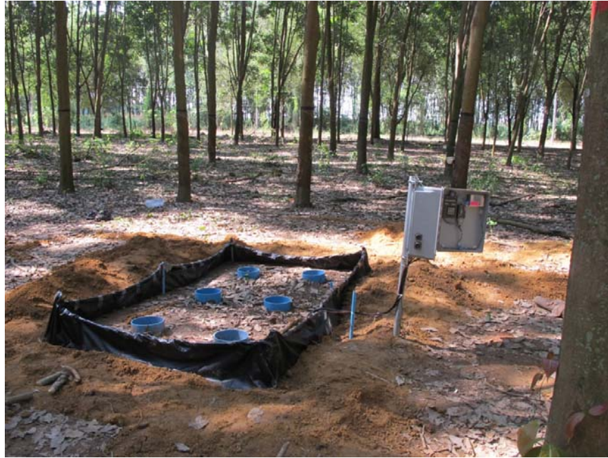
รูปที่ 2-23 Trench plot ที่เสร็จเรียบร้อยแล้ว พร้อมกับชุดอุปกรณ์บันทึกอุณหภูมิดินและปริมาณน้ำในดินแบบอัตโนมัติ
