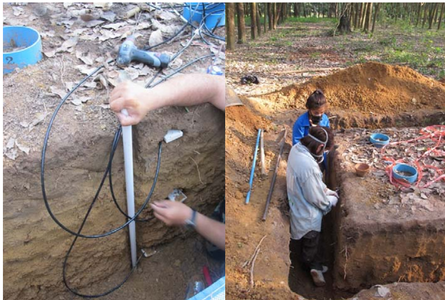
รูปที่ 2-20 การติดตั้ง sensor วัดอุณหภูมิดินและปริมาณน้ำในดิน (ภาพซ้าย) และ การทายาฆ่ารากที่อยู่ภายใน Trench plot (ภาพขวา)
