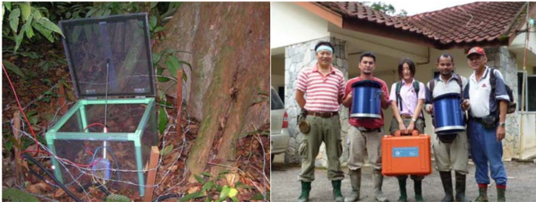
รูปที่ 2-31 Multi-channel automated chamber systems ซึ่งติดตั้งในพื้นที่ศึกษา (รูปซ้าย) และตัวอย่างของ Portable automated chamber system (รูปขวา) ที่พัฒนาขึ้นโดย Dr. Naishen Liang (Liang, 2010)
