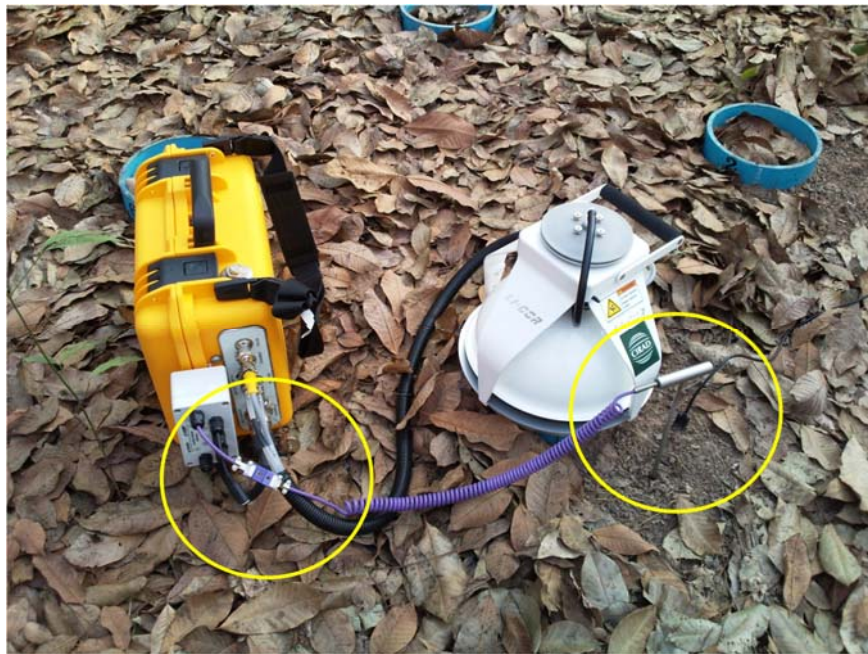
รูปที่ 2-25 อุปกรณ์วัดอุณหภูมิดิน (T handle thermocouple) ซึ่งสามารถเชื่อมต่อกับเครื่องวัดอัตราการหายใจของดินได้
