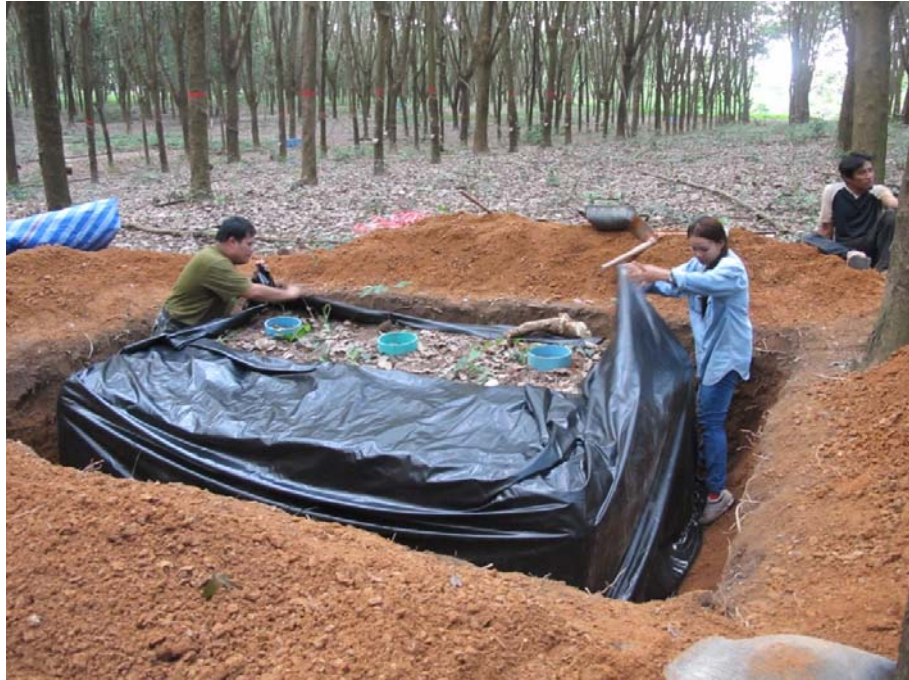
รูปที่ 2-21 การนำพลาสติกพันรอบพื้นผิวด้านข้างของ Trench plot เพื่อป้องกันไม่ให้รากเจริญเข้ามาใน Trench plot
