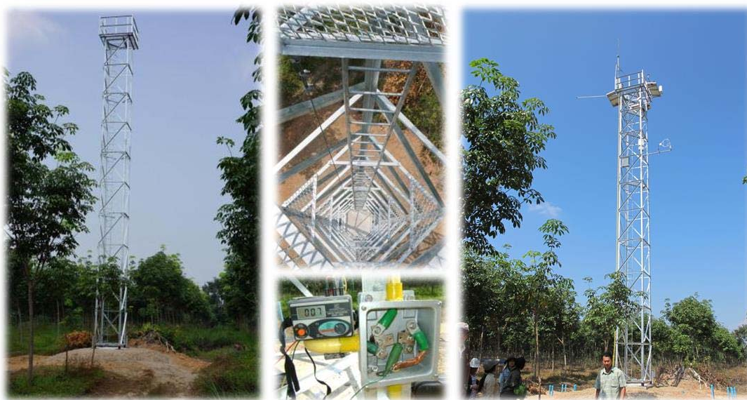
รูปที่ 2-5 หอคอย ความสูง 15 เมตร ใช้สำหรับติดตั้งชุดอุปกรณ์ Eddy Covariance และชุดอุปกรณ์ตรวจวัดสภาพภูมิอากาศ ณ พื้นที่ศึกษา Site ที่ 2 สวนยางพาราของเกษตรกร อำเภอปากคาด จังหวัดบึงกาฬ
