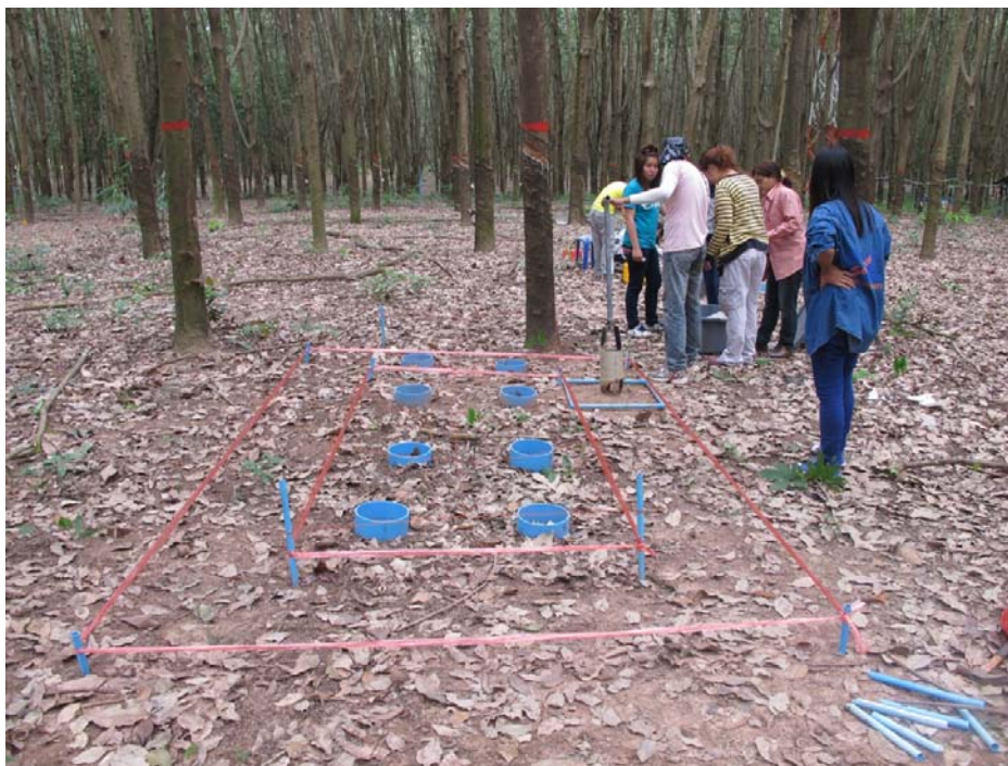
รูปที่ 2-18 การกำหนดพื้นที่ในการขุดดินเพื่อทำ Trench plot และเก็บตัวอย่างราก และดิน
