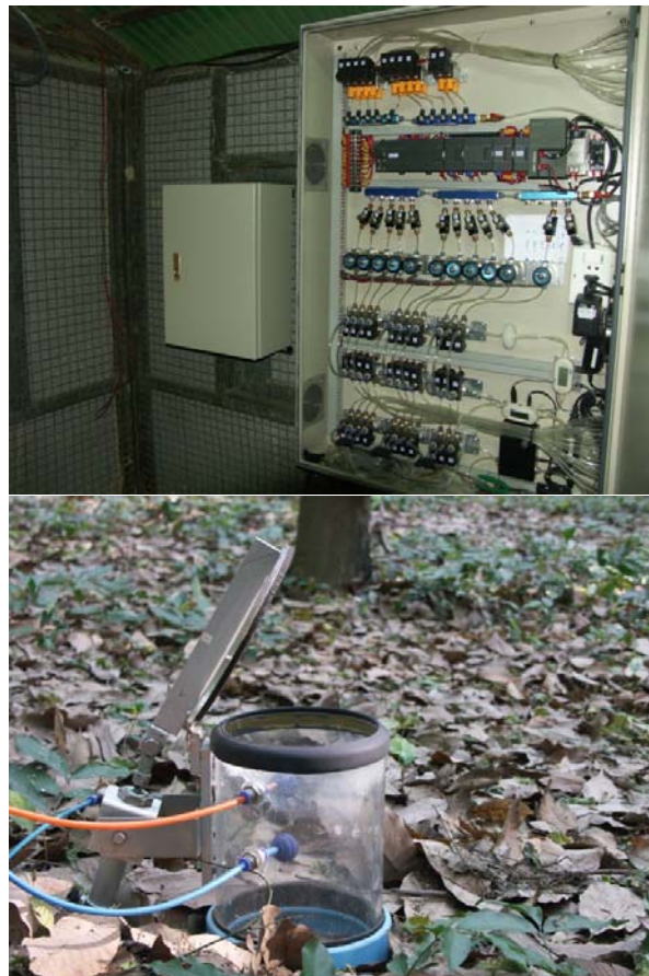
รูปที่ 2-30 ชุดอุปกรณ์วัดอัตราการหายใจของดินแบบอัตโนมัติที่พัฒนาขึ้น โดยประกอบด้วย ระบบควบคุมการทำงานของชุดอุปกรณ์และการไหลเวียนของอากาศภายในระบบ (รูปบน) และ Chamber สำหรับวัดอัตราการหายใจของดิน (รูปล่าง)
