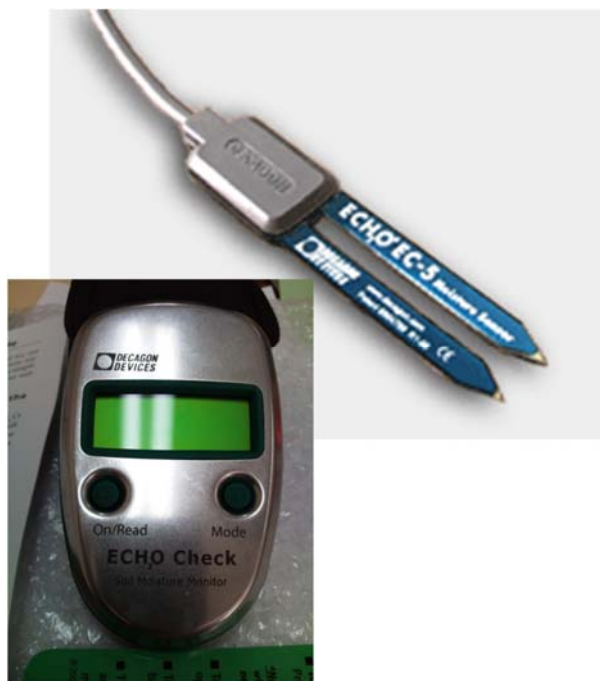
รูปที่ 2-26 อุปกรณ์วัดปริมาณน้ำในดิน (Soil moisture sensor) รุ่น EC-5 (Decagon Devices, Inc.m U.S.A.) ซึ่งอ่านค่าที่วัดได้โดยใช้ ProCheck (Decagon Devices, Inc.m U.S.A.)
