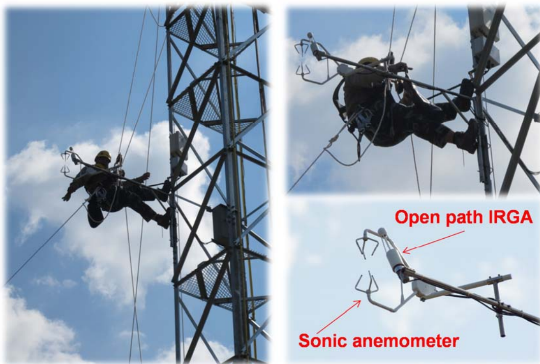
รูปที่ 2-6 การติดตั้งชุดอุปกรณ์ Eddy Covariance ณ พื้นที่ศึกษา Site ที่ 2 สวนยางพาราของเกษตรกร อำเภอปากคาด จังหวัดบึงกาฬ
