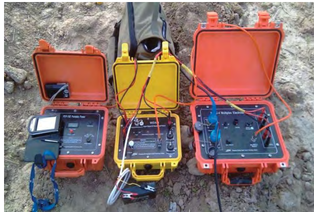
ภาพที่ ก-4 การจัดวางเครื่องมือสำรวจวัดค่าสภาพ ต้านทาน ไฟฟ้า WDA-1
