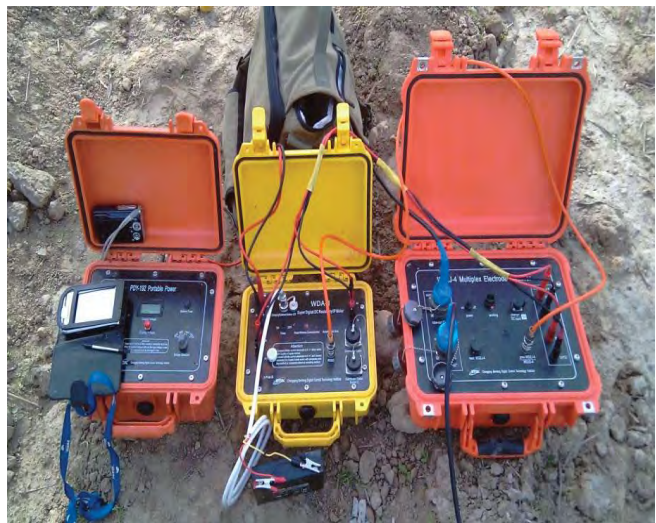
ภาพที่ 3-5 การจัดวางเครื่องมือสำรวจวัดค่าสภาพต้านทาน ไฟฟ้า WDA-1
