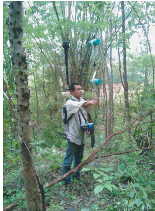
ภาพที่ 3-6 การสำรวจวัดค่าสนามแม่เหล็กด้วยเครื่องมือที่สามารถวัดค่าแบบ เกรเดียน โดยใช้ sensor 2 ตัวพร้อมกัน เริ่มอ่านค่าที่ Base Station แล้วทำการอ่านค่าตามเส้นสำรวจโดยมี GPS บันทึกตำแหน่งพร้อมกัน
