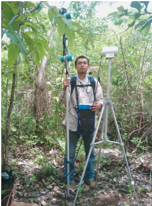
ภาพที่ 3-6 การสำรวจวัดค่าสนามแม่เหล็กด้วยเครื่องมือที่สามารถวัดค่าแบบ เกรเดียน โดยใช้ sensor 2 ตัวพร้อมกัน เริ่มอ่านค่าที่ Base Station แล้วทำการอ่านค่าตามเส้นสำรวจโดยมี GPS บันทึกตำแหน่งพร้อมกัน
