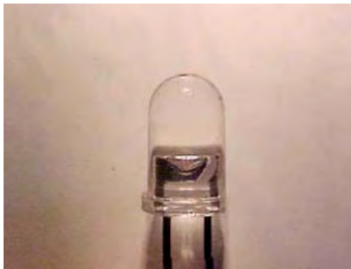
ภาพที่ ๔.๑๑ ลักษณะและโครงสร้างภายในของหลอด LED
