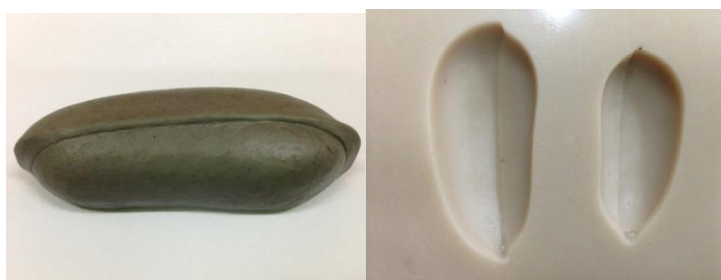
ภาพที่ 99แม่พิมพ์ข้าวต้นแบบที่ปั้นด้วยดินน้ำมันแสดงภาพด้านบน (ซ้าย) และพิมพ์ซิลิโคนสำหรับกดขนม (ขวา)
