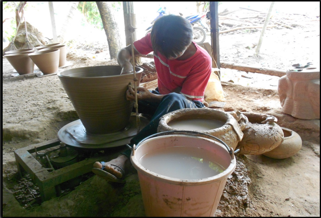
ภาพที่ 5-6 :ช่างปั้นกำลังปั้นและออกแบบงานดินเผาตามรูปทรง
