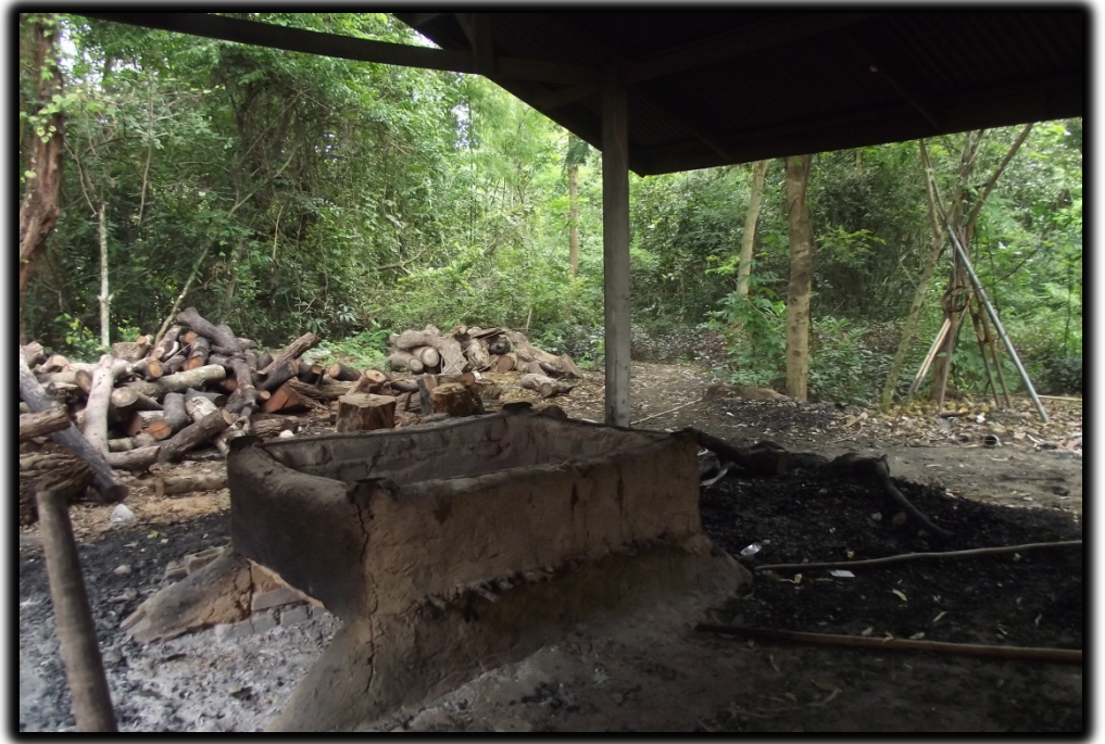
ภาพที่ 7: เตาอุ่นเต้าก่อนจะถูกนำไปเททองเหลือง
