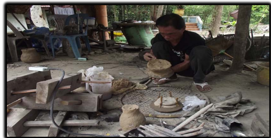
ภาพที่ 6: การโอบด้วยดินอีกชั้น เพื่อเป็นเท้าสำหรับทองเหลือง
