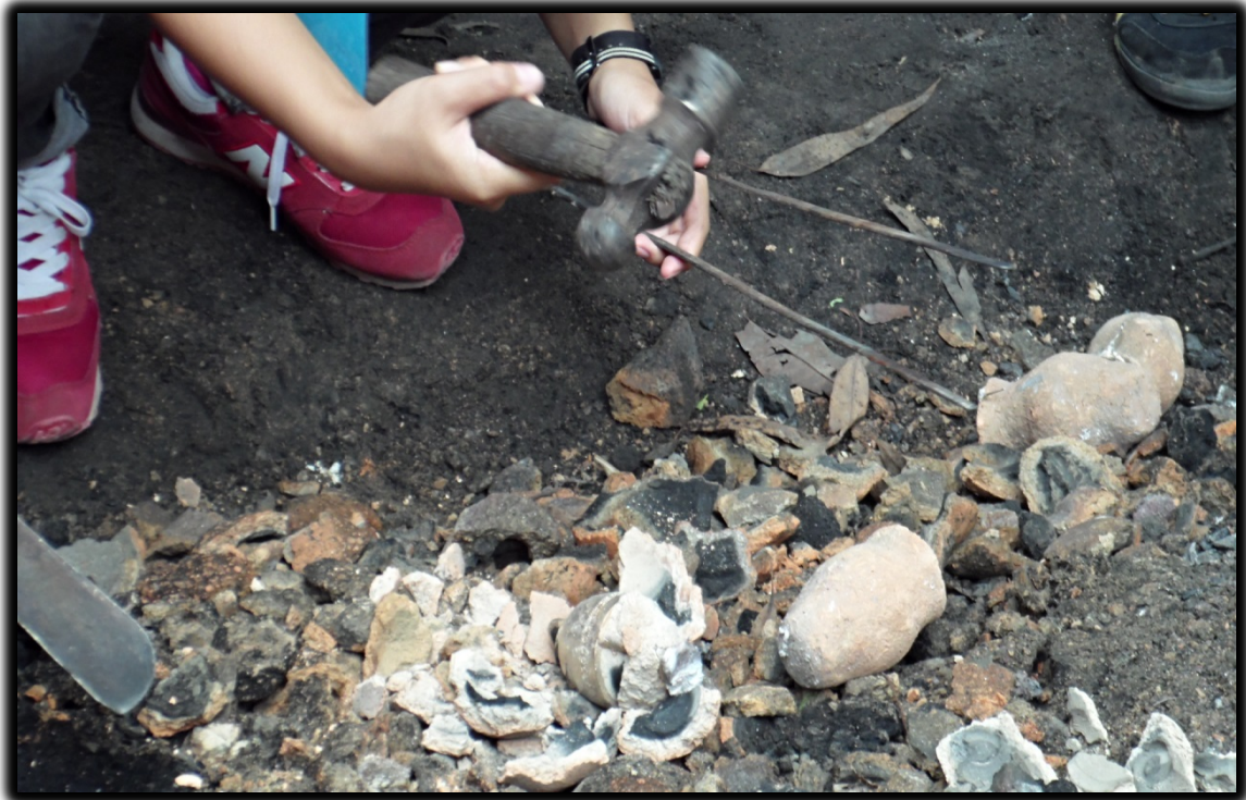
ภาพที่ 11-12 : หลังจากเข้าเย็นก็ทำการกระเทาะเบ้าออกจะเห็นทองเหลืองที่ถูกหลอม ตามรูปทรงและลวดลายที่กำหนด
