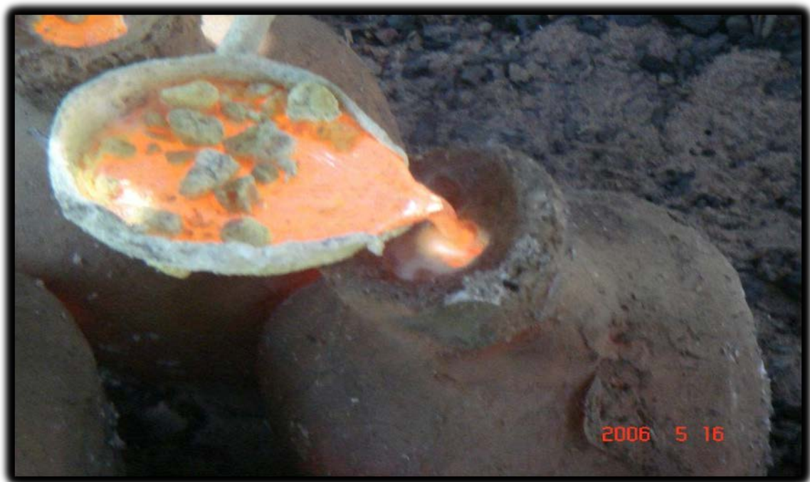
ภาพที่ 10 : การเททองเหลืองลงในเบ้าด้วยความระมัดระวัง
