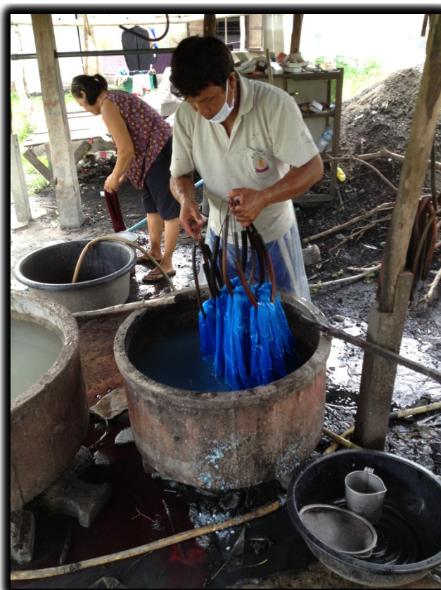
ภาพที่ 4 : การล้างเส้นไหมที่ย้อมด้วยน้ำแป้งมันเพื่อให้สีติดทน
