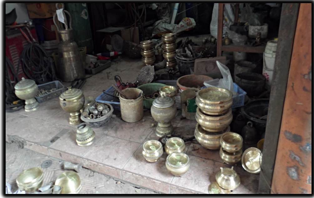
ภาพที่ 13-14 : ผลิตภัณฑ์ทองเหลืองจะถูกนำมาตกแต่งความสวยงาม การขัด การเจียร และการกลึงให้ได้รูปทรงและขนาดตามที่ต้องการ
