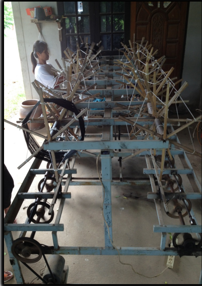
ภาพที่ 5 : การปั่นเส้นไหมหลังจากย้อมสีเสร็จเพื่อแยกขนาดของเส้นไหม
