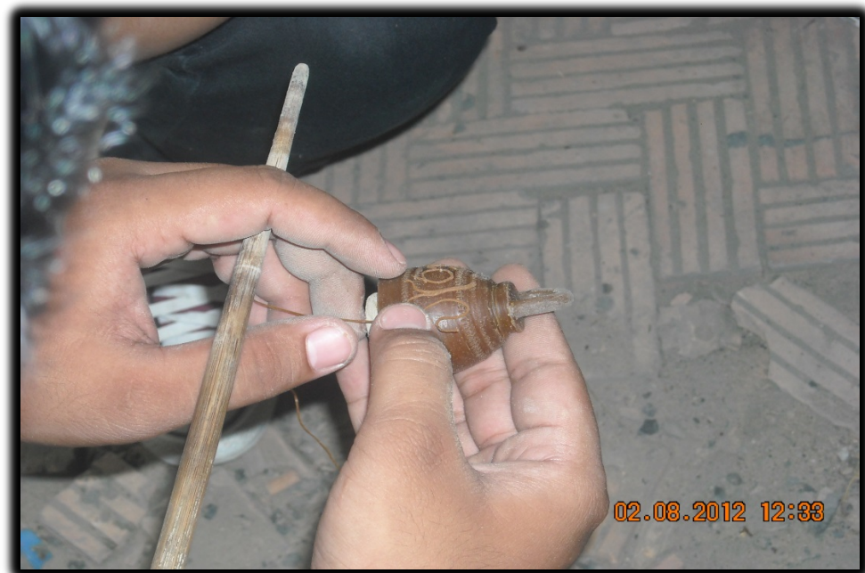
ภาพที่ 4: การขึ้นลายโดยใช้เส้นขี้ผึ้ง
