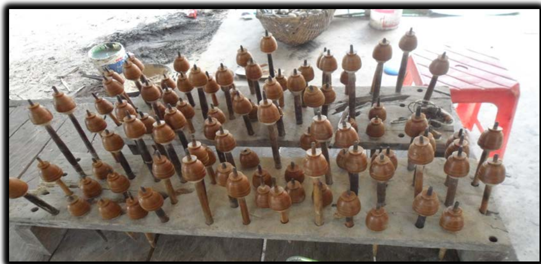
ภาพที่ 5 : ชิ้นลายเสร็จจะถูกนำไปผึ่งก่อนนำไปโอบด้วยดินอีกชั้น เพื่อเป็นเท้าสำหรับทองเหลือง
