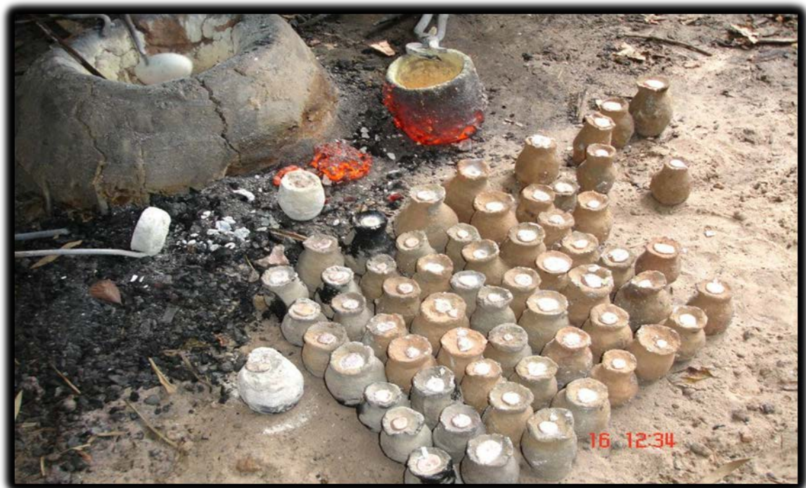
ภาพที่ 9 : การเททองเหลืองที่ถูกหลอมเรียบร้อยแล้วลงในเบ้า
