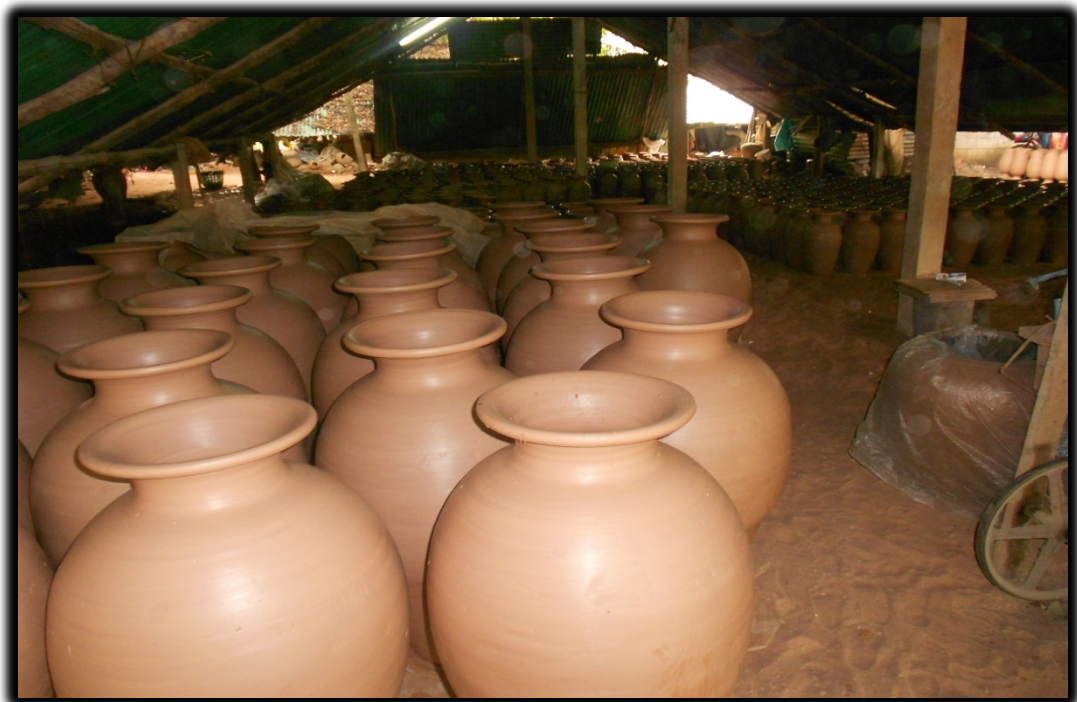
ภาพที่ 7-8 :รูปทรงต่างๆ ของงานดินเผาหลังจากที่ปั้นเสร็จก็จะเข้าสู่ขั้นตอนการเผา
