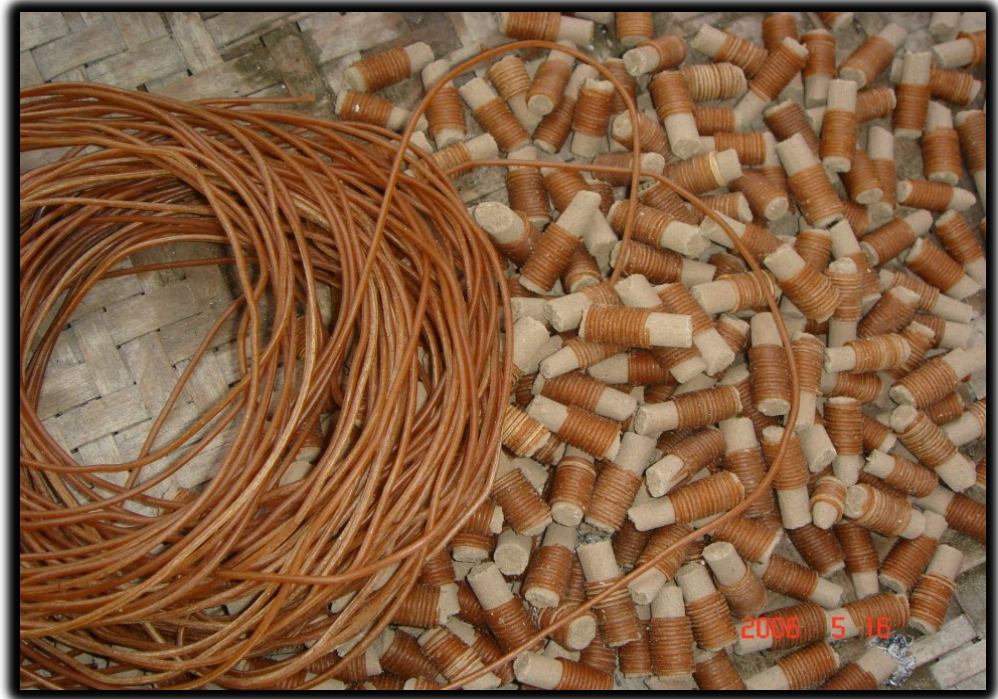
ภาพที่ 3: ขี้ผึ้งที่ถูกหลอมแล้วจะนำมาขึ้นลาย
