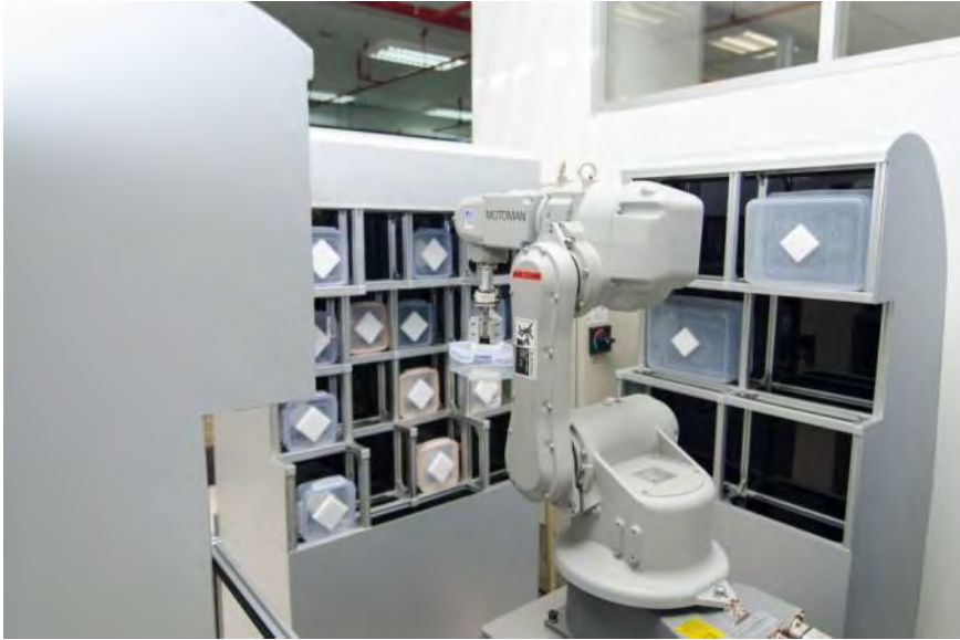
ภาพประกอบที่ 5.4.7: ภาพแขนหุ่นยนต์ขณะทำการหยิบบรรจุภัณฑ์ที่ไปวางลงบนชั้นใส่ยา
