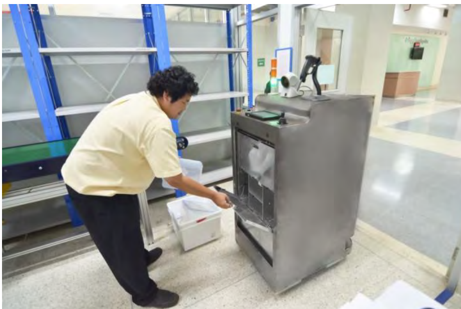
ภาพประกอบที่ 5.4.9: ภาพที่ปลายทางของสายพานลำเลียงซึ่งมีหุ่นยนต์เคลื่อนที่อัจฉริยะ ประเภทยานำวิถีแบบอัตโนมัติคอยรับส่งต่อบรรจุภัณฑ์ยา
