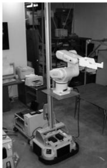
ภาพประกอบที่ 2.1.2: แขนหุ่นยนต์อุตสาหกรรมที่เชื่อมต่อกับฐานหุ่นยนต์ที่สามารถเคลื่อนที่ขึ้นลงในแนวดิ่ง
