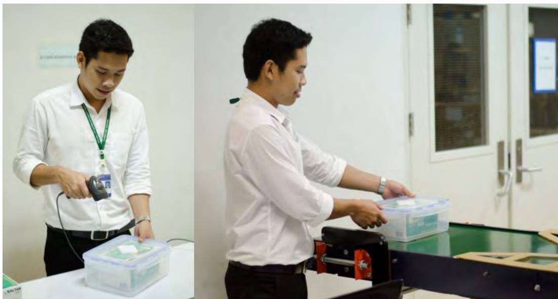
ภาพประกอบที่ 5.4.5: ภาพการอ่านค่าฝาบรรจุภัณฑ์และการนำบรรจุภัณฑ์วางลงบนสายพานลำเลียงขาเข้า
