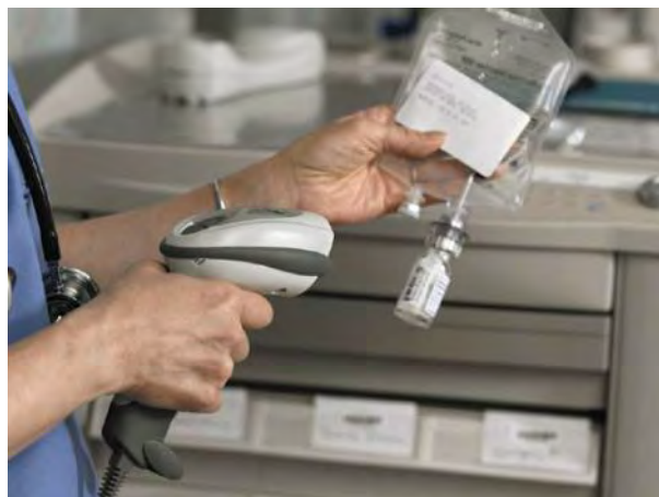
ภาพประกอบที่ 1.5.1: การติตรหัสข้อมูลเชิงเส้นสำหรับจำแนกชนิดหรือประเภทของยา[8]
