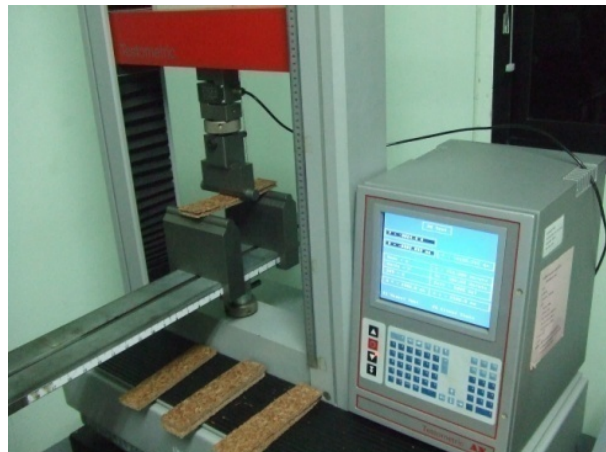
รูปที่ 4.5 การทดสอบความแข็งแรงตัดและมอดูลัสยืดหยุ่น
