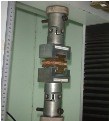
รูปที่ 4.6 การทดสอบแรงดึงตั้งฉากกับผิวหน้า
