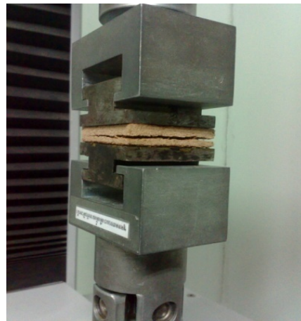
รูปที่ 4.6 การทดสอบแรงดึงตั้งฉากกับผิวหน้า
