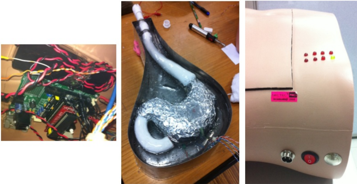
รูปที่ 8 ระบบเซ็นเซอร์พร้อมทั้งส่วนแสดงผลที่ถูกติดตั้งลงในหุ่นจำลองระบบทางเดินอาหารส่วนบน
