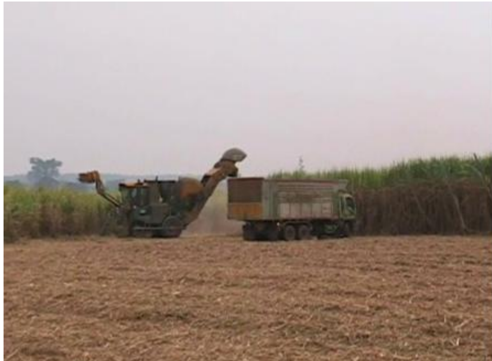
ภาพที่ 20 การทดสอบหาเวลาที่ใช้ในการกลับเลี้ยวบริเวณหัวแปลงอ้อย
