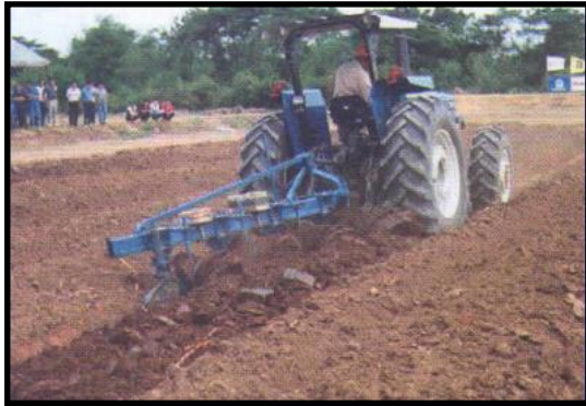
ภาพที่ 4 การเตรียมดินเพาะปลูกอ้อย ใช้ไถงานแบบสามผาล และไถระเบิดดินดาน
