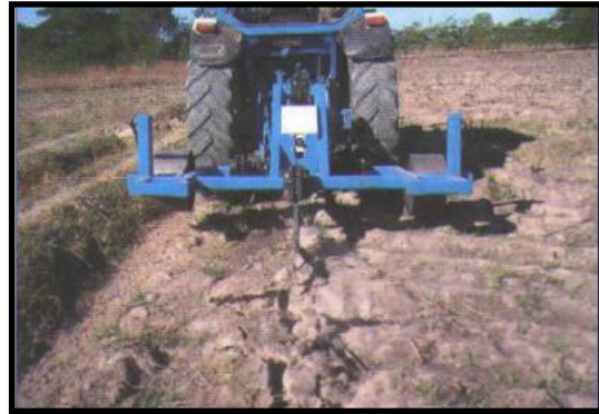
ภาพที่ 4 การเตรียมดินเพาะปลูกอ้อย ใช้ไถงานแบบสามผาล และไถระเบิดดินดาน
