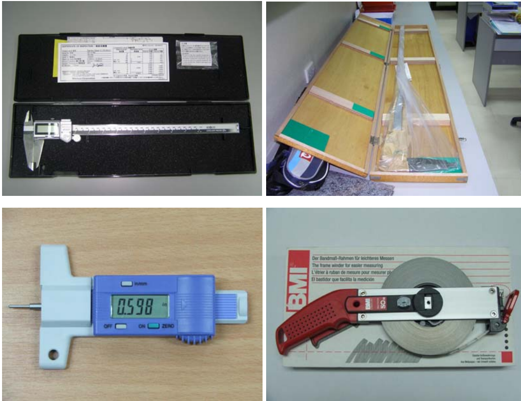
รูปที่ 3 เครื่องมือที่ใช้วัดมิติของยางล้อต้นสำหรับรถฟอร์กลิฟต์
