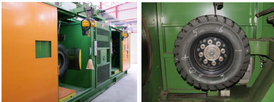
รูปที่ 6 เครื่องทดสอบความทนทานของยางล้อ (Drum Tire Testing)
