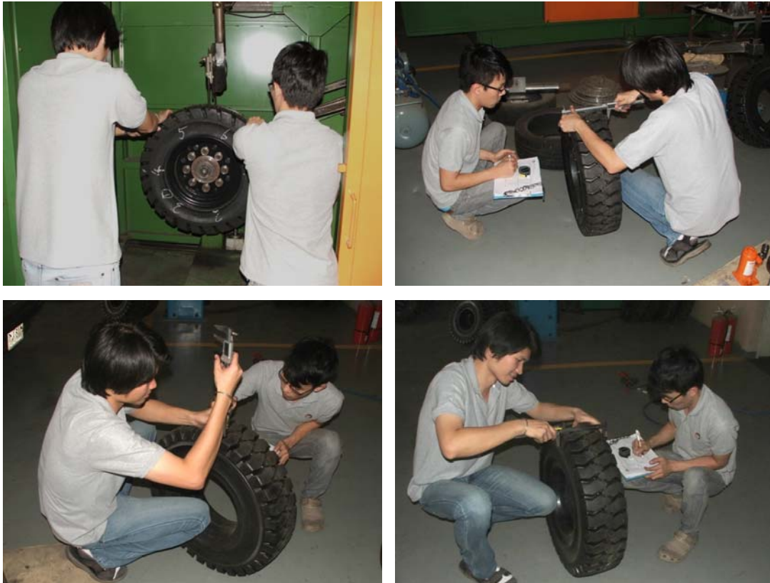
รูปที่ 5 แสดงการวัดมิติของยางล้อต้นสำหรับรถฟอร์กลิฟต์
