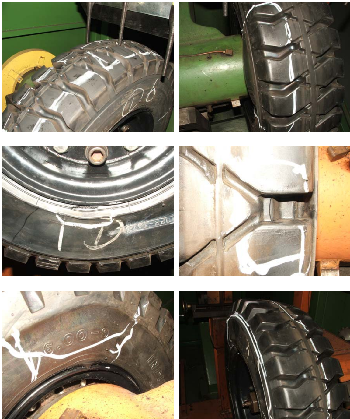
รูปที่ 9 ตัวอย่างความเสียหายของยางล้อต้นในการทดสอบ
