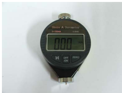
รูปที่ 2 เครื่องมือที่ใช้วัดความแข็งของยางล้อตันสำหรับรถฟอร์กลิฟต์
