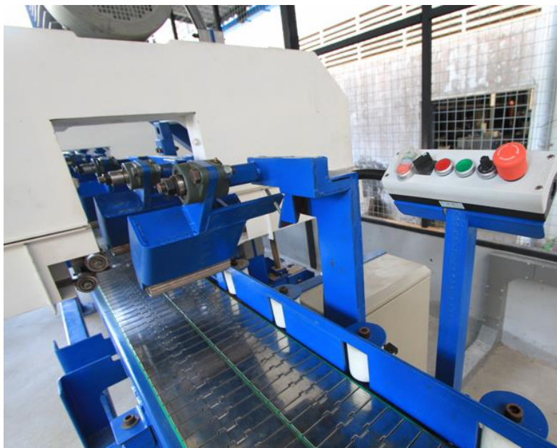
รูปที่ 5.4 สายพานป้อนและลูกกลิ้งกด
