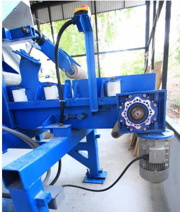
รูปที่ 5.5 ระบบขับเคลื่อนสายพานป้อนและแปรง
