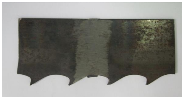
รูปที่ 3.11 ชิ้นงานหลังการเชื่อมที่ตัวแปร MIG
