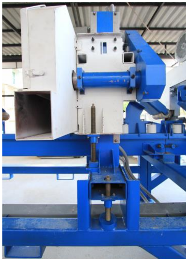
รูปที่ 5.6 ระบบปรับระยะสูงต่ำและระดับความเอียงใบเลื่อย
