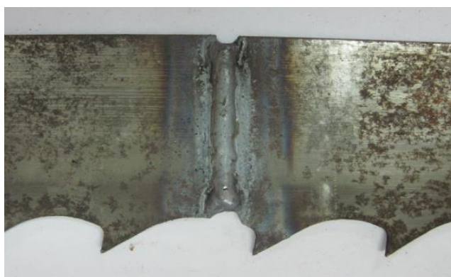
รูปที่ 3.9 ชิ้นงานหลังการเชื่อมที่ตัวแปร เชื่อมสองด้าน, Post Heat 350 °C, 15 นาที
