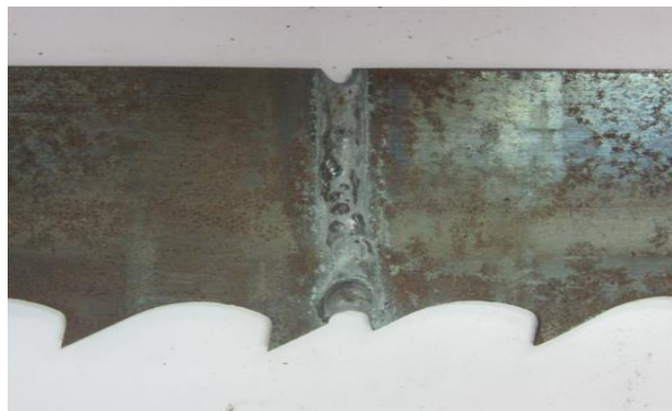
รูปที่ 3.10 ชิ้นงานหลังการเชื่อมที่ตัวแปร เชื่อมสองด้าน, Post Heat 500 °C, 18 วินาที
