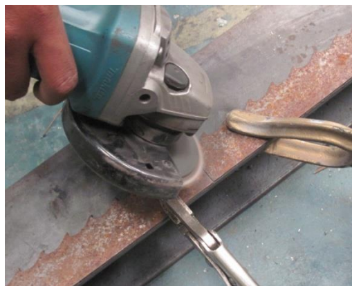
รูปที่ 3.4 การขัดผิวสนิมก่อนการเชื่อม
