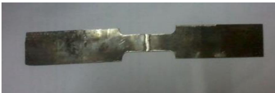
รูปที่ 3.13 ลักษณะชิ้นงานที่ใช้ทดสอบการดึง
