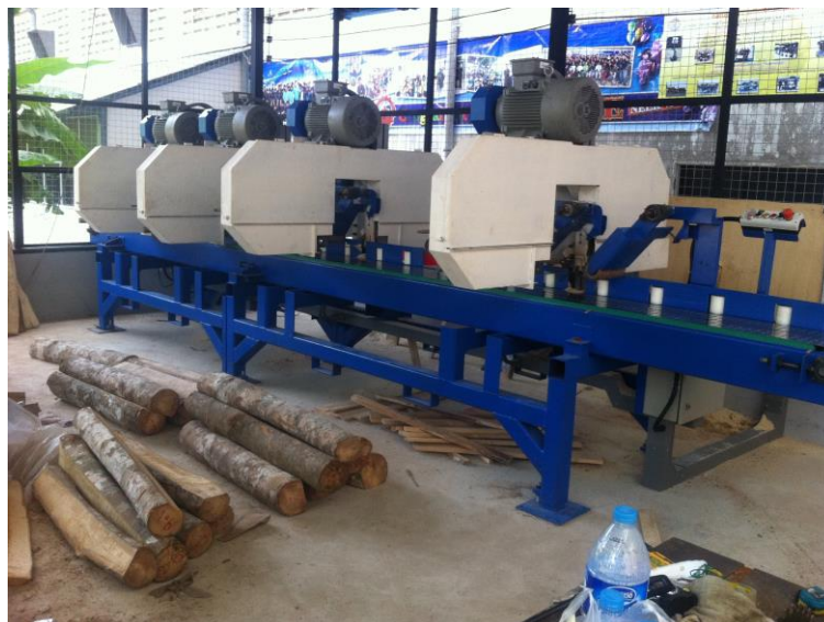
รูปที่ 5.8 แสดงชุดเลื่อยครบทั้ง 4 ชุด ที่อยู่ระหว่างการทดสอบ
