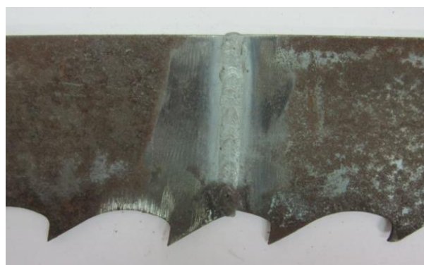
รูปที่ 3.7 ชิ้นงานหลังการเชื่อมที่ตัวแปร เชื่อมด้านเดียว, Post Heat 350 °C, 15 นาที
