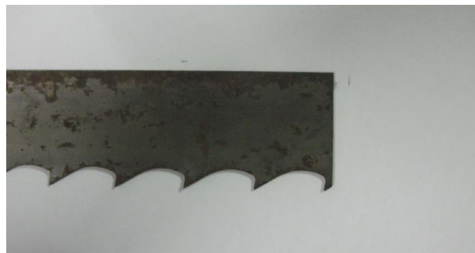
รูปที่ 3.2 ผิวรอยต่อของชิ้นงานก่อนการเชื่อม
