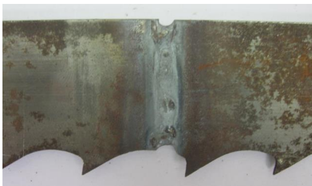
รูปที่ 3.8 ชิ้นงานหลังการเชื่อมที่ตัวแปร เชื่อมด้านเดียว, Post Heat 500 °C, 18 วินาที
