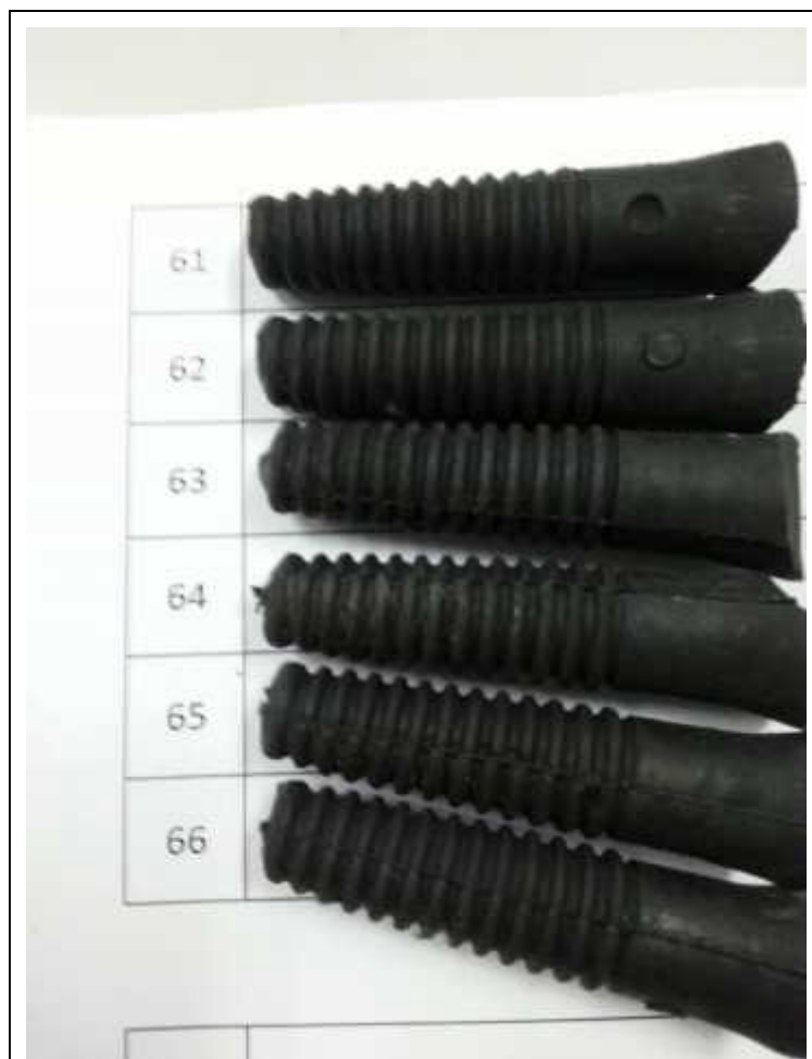
รูปที่ 79 ยางถนนโกที่ได้จากโครงการ หลังการทดสอบ (ต่อ)
