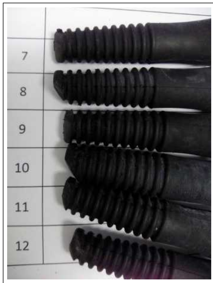
รูปที่ 70 ยางถนนไก่ที่ได้จากโครงการหลังการทดสอบ (ต่อ)
