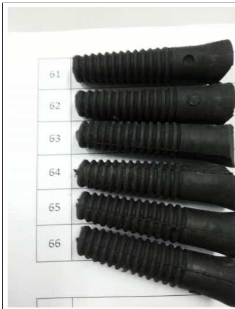
รูปที่ 56 ยางถนนไนท์ DURAM หลังการทดสอบ (ต่อ)
