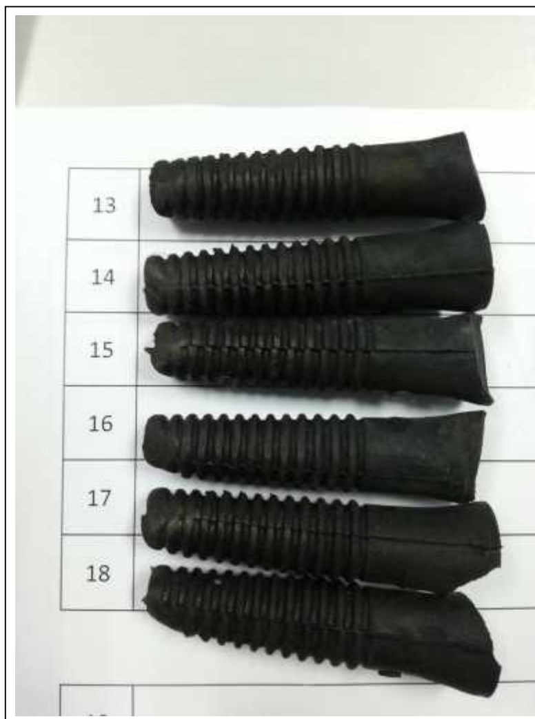
รูปที่ 48 ยางถอนขนไก่ DURAM หลังการทดสอบ (ต่อ)
