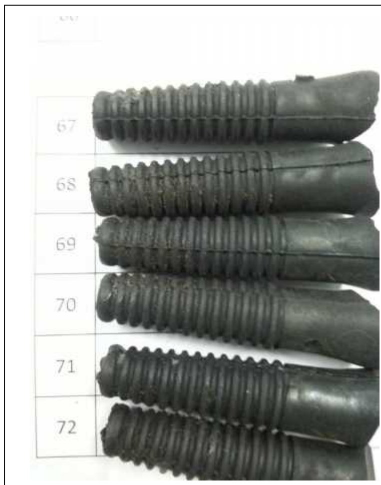
รูปที่ 80 ยางถอนขนไก่ที่ได้จากโครงการ หลังการทดสอบ (ต่อ)
