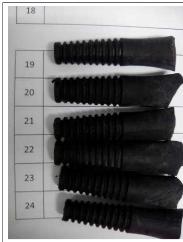
รูปที่ 72 ยางถอนขนไก่ที่ได้จากโครงการ หลังการทดสอบ (ต่อ)
