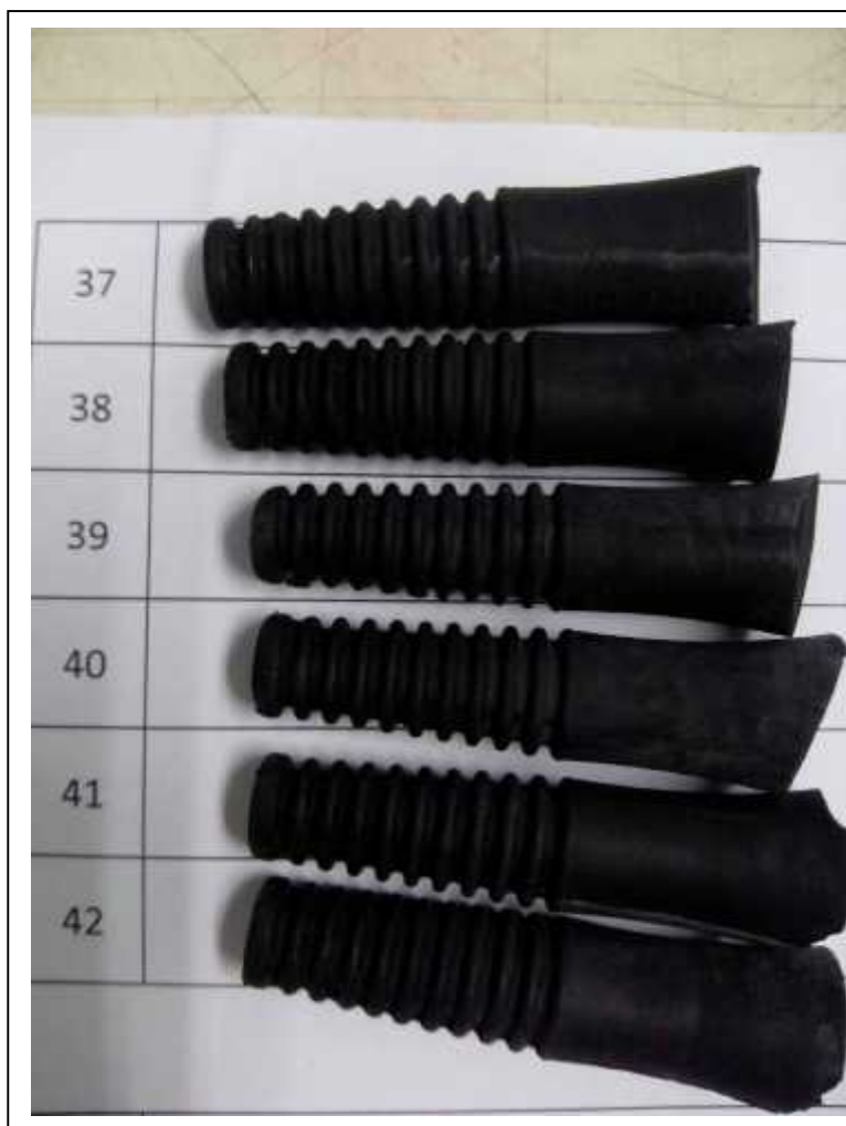
รูปที่ 75 ยางถอนขนไก่ที่ได้จากโครงการ หลังการทดสอบ (ต่อ)
