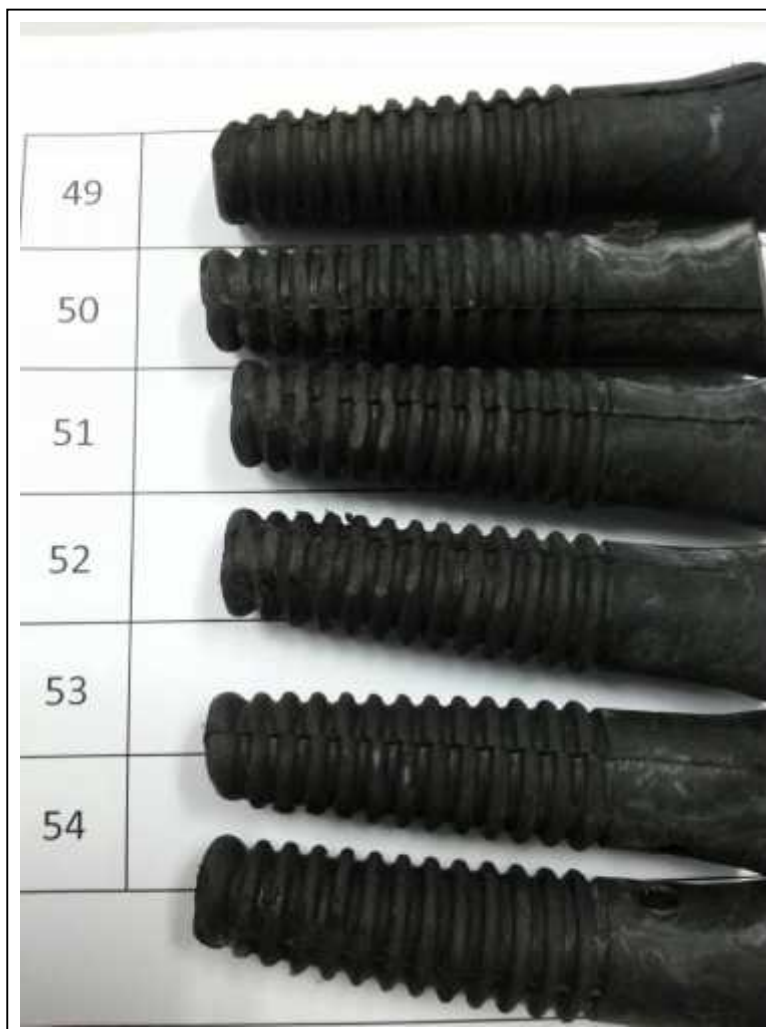
รูปที่ 54 ยางถอนขนไก่ DURAM หลังการทดสอบ (ต่อ)
