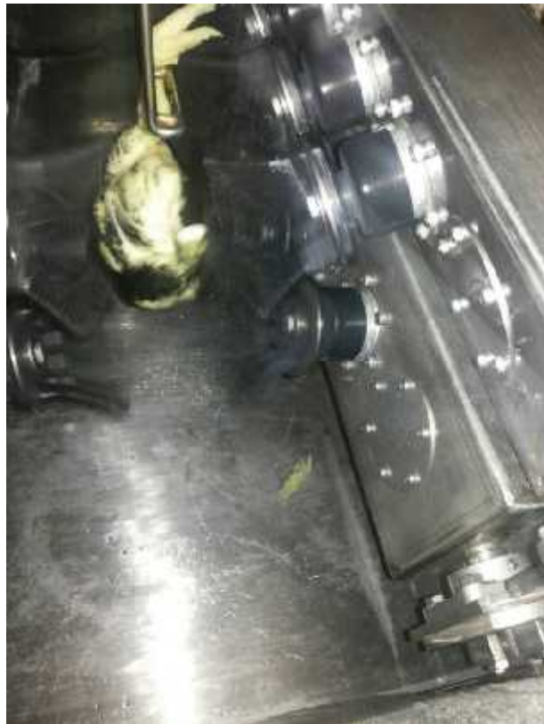
รูปที่ 59 การทดสอบแบบมี Load กับยางถอนขนไก่ DURAM
