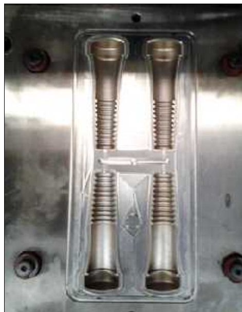
รูปที่ 17 แม่พิมพ์ฉีดยางถนนไนท์ (ต่อ)
