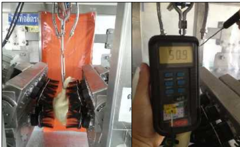
รูปที่ 23 ระบบการฉีดน้ำใส่ไก่
