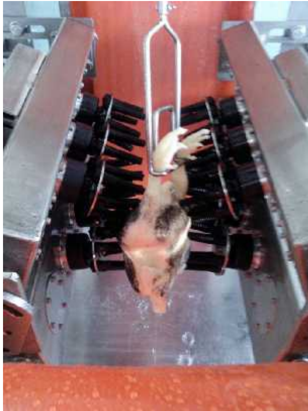
รูปที่ 58 การทดสอบแบบมี Load กับยางถอนขนไก่ DURAM
