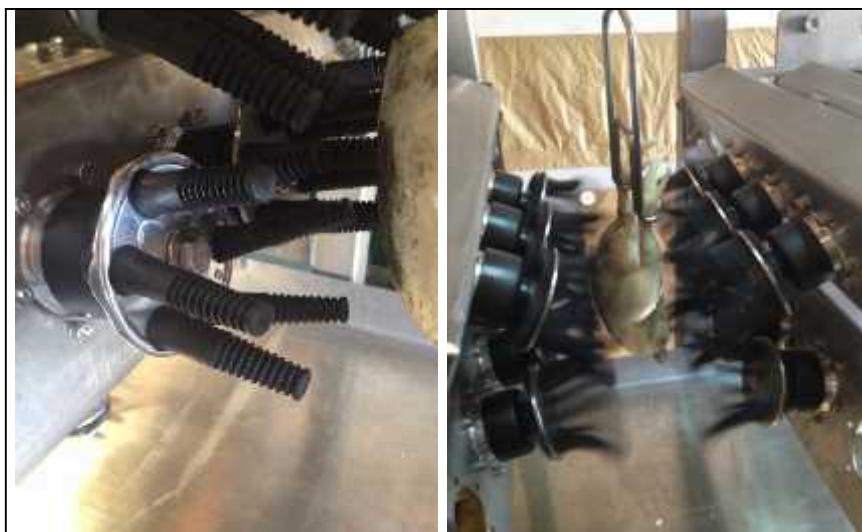
รูปที่ 24 ระบบการจับยึดลูกยาง
