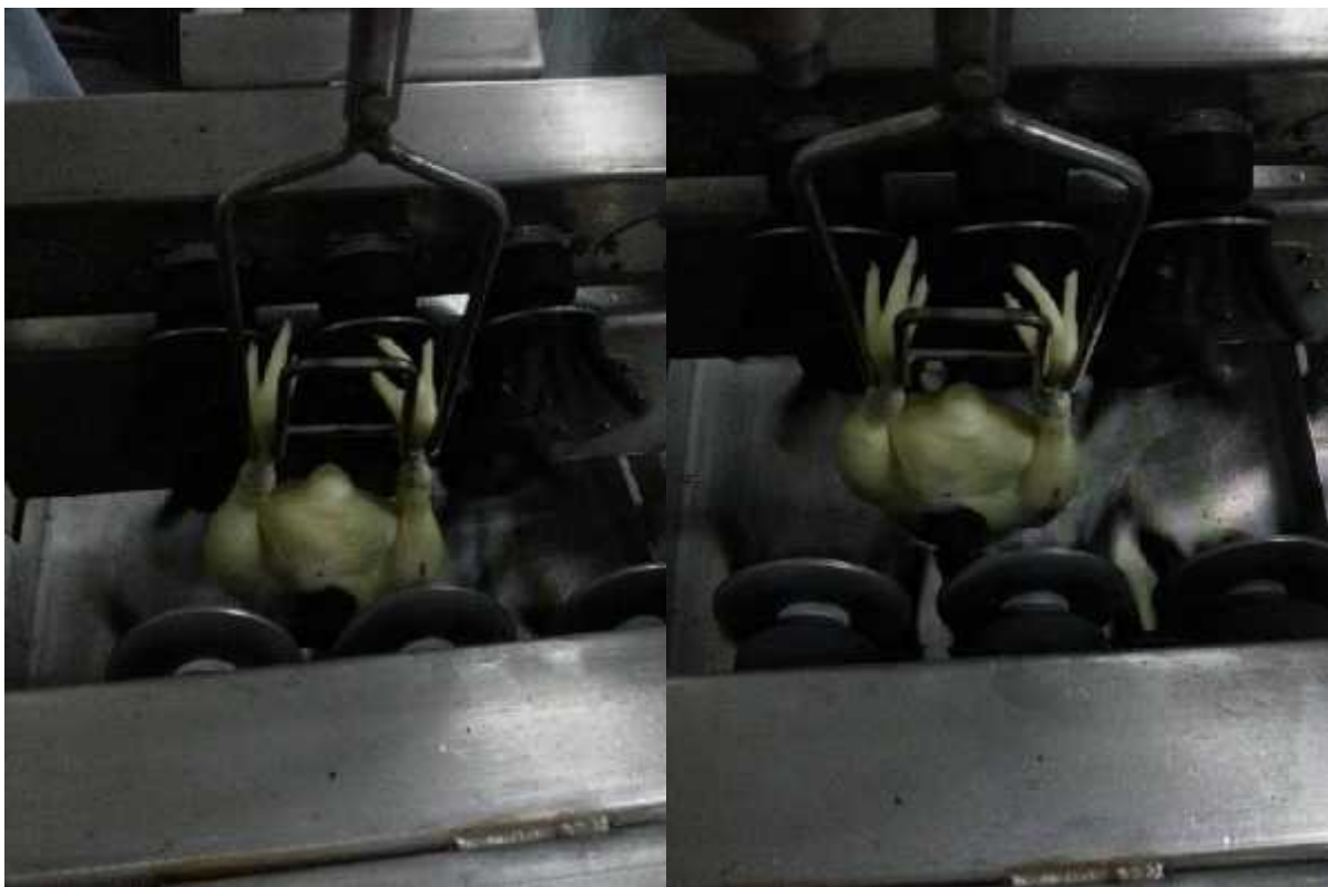
รูปที่ 61 การทดสอบแบบมี Load กับยางถอนขนไก่ DURAM
