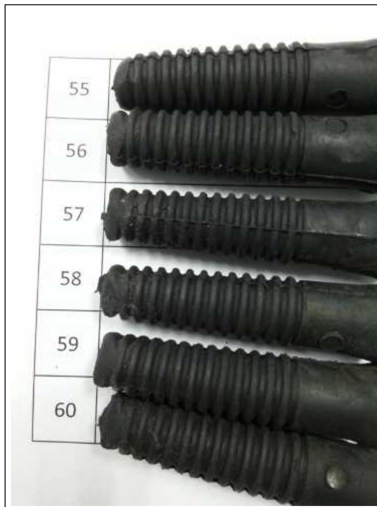
รูปที่ 55 ยางถนนไนท์ DURAM หลังการทดสอบ (ต่อ)
