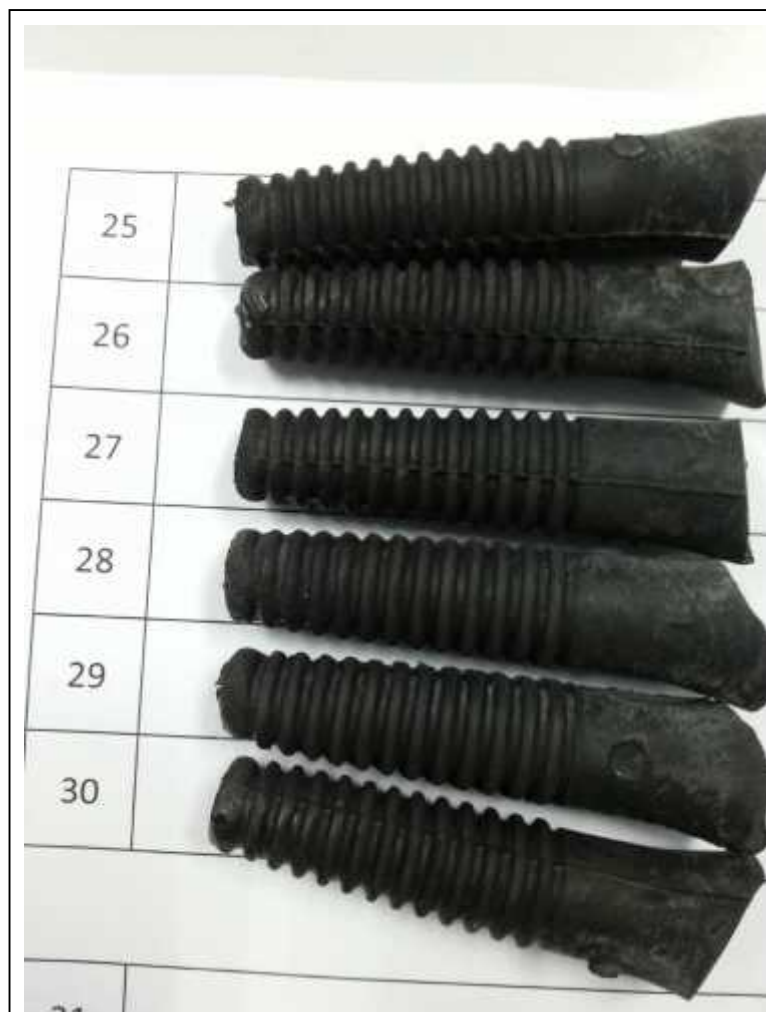
รูปที่ 50 ยางถนนไนท์ DURAM หลังการทดสอบ (ต่อ)
