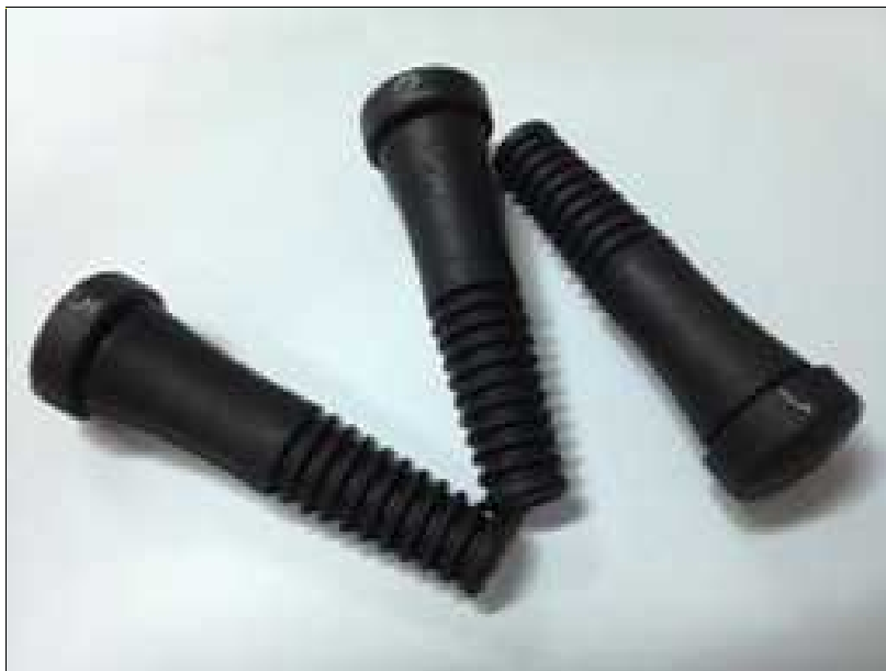
รูปที่ 19 ชิ้นงานยางถอนขนไก่แบบใหม่ (แบบที่ 02)
