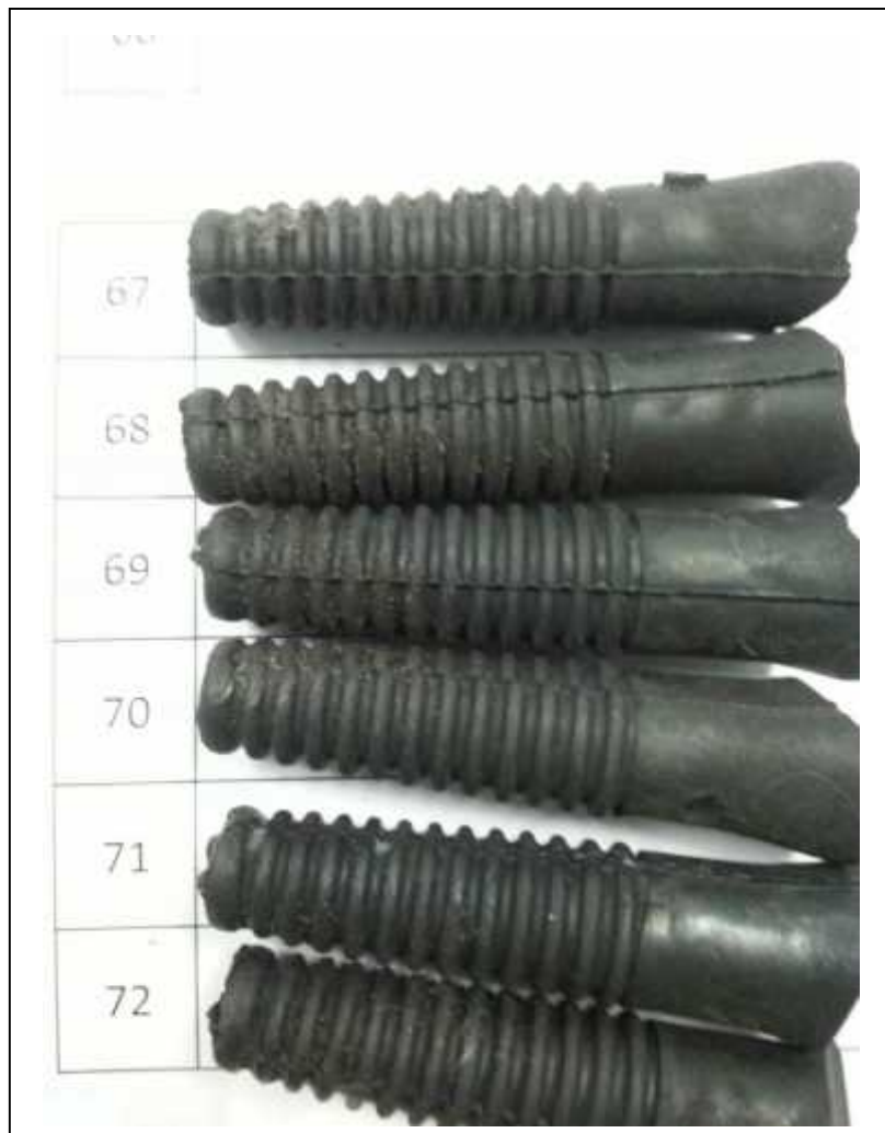
รูปที่ 57 ยางถนนไนท์ DURAM หลังการทดสอบ (ต่อ)
