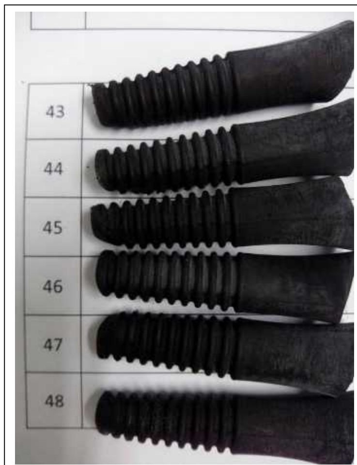
รูปที่ 76 ยางถอนขนไก่ที่ได้จากโครงการ หลังการทดสอบ (ต่อ)
