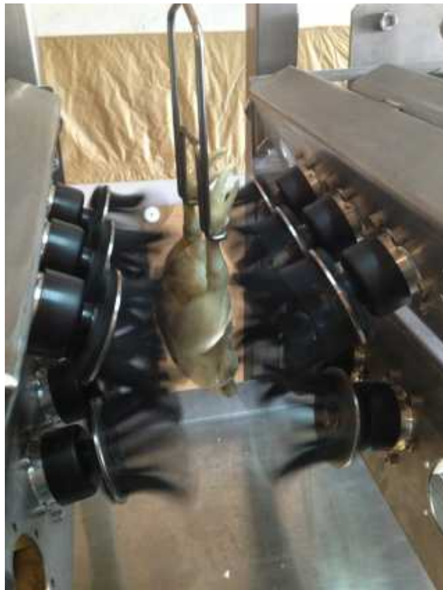
รูปที่ 65 การทดสอบแบบมี Load กับยางถอนขนไก่ DURAM
