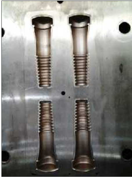
รูปที่ 18 แม่พิมพ์ฉีดยางถอนขนไก่ (ต่อ)
