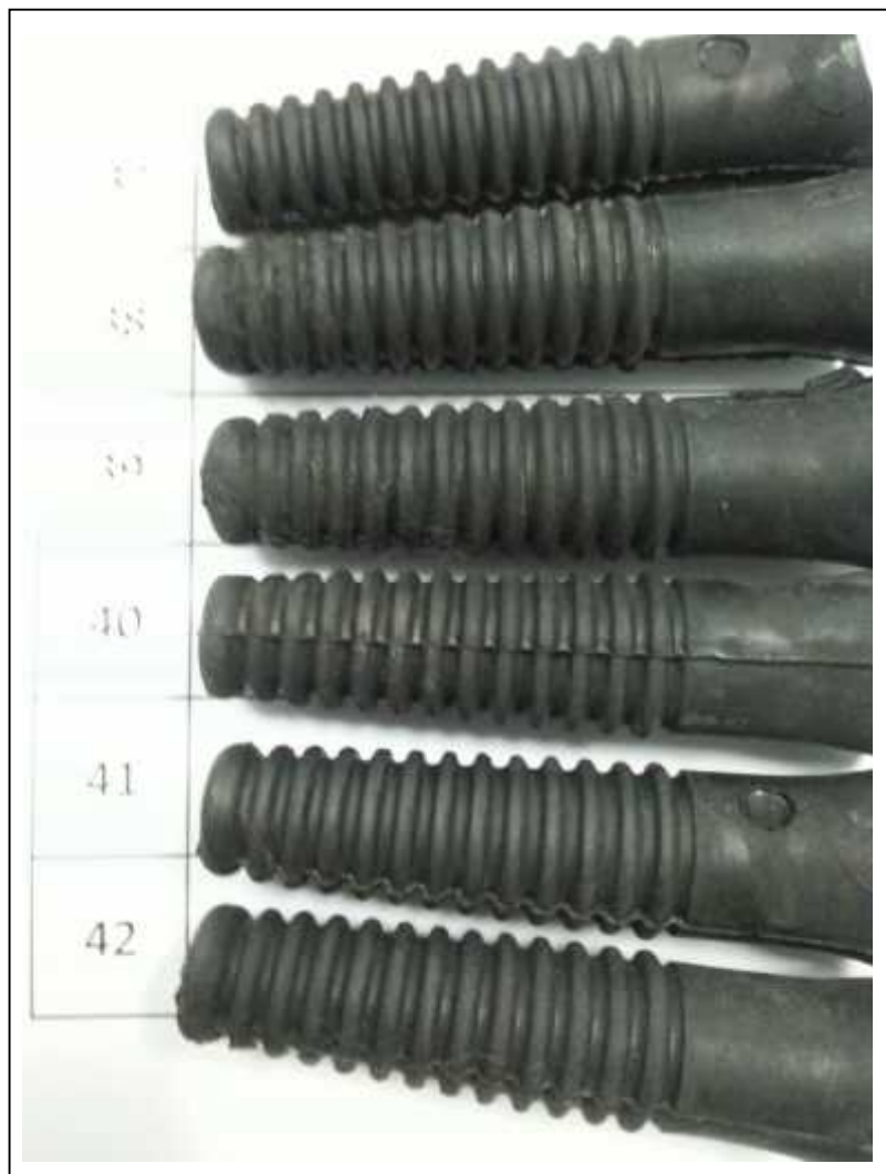
รูปที่ 52 ยางถนนไนท์ DURAM หลังการทดสอบ (ต่อ)
