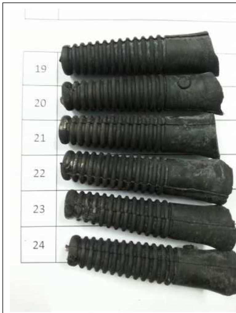
รูปที่ 489ยางถอนขนไก่ DURAM หลังการทดสอบ (ต่อ)
