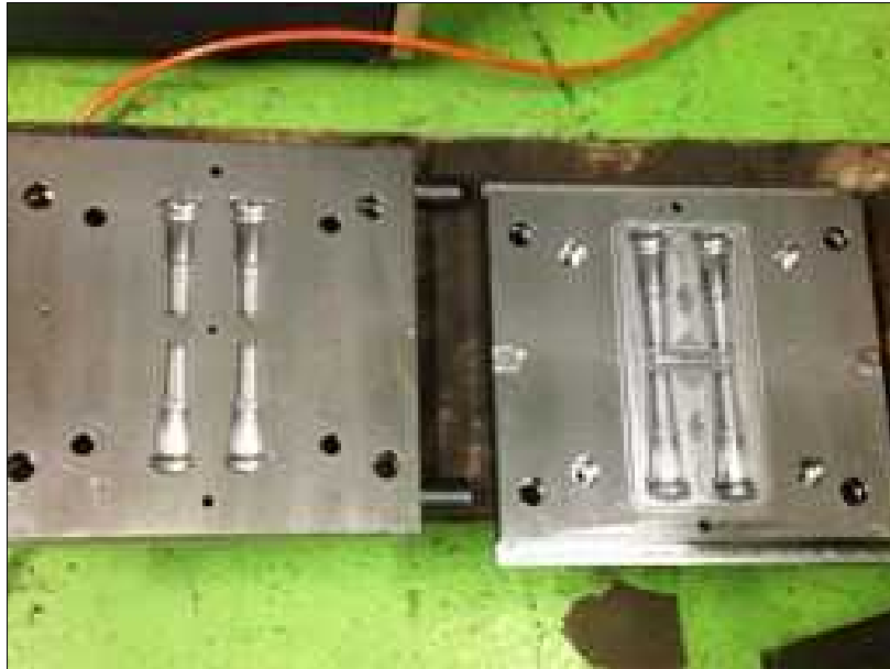
รูปที่ 16 แม่พิมพ์ฉีดยางถนนไนท์ (1)
