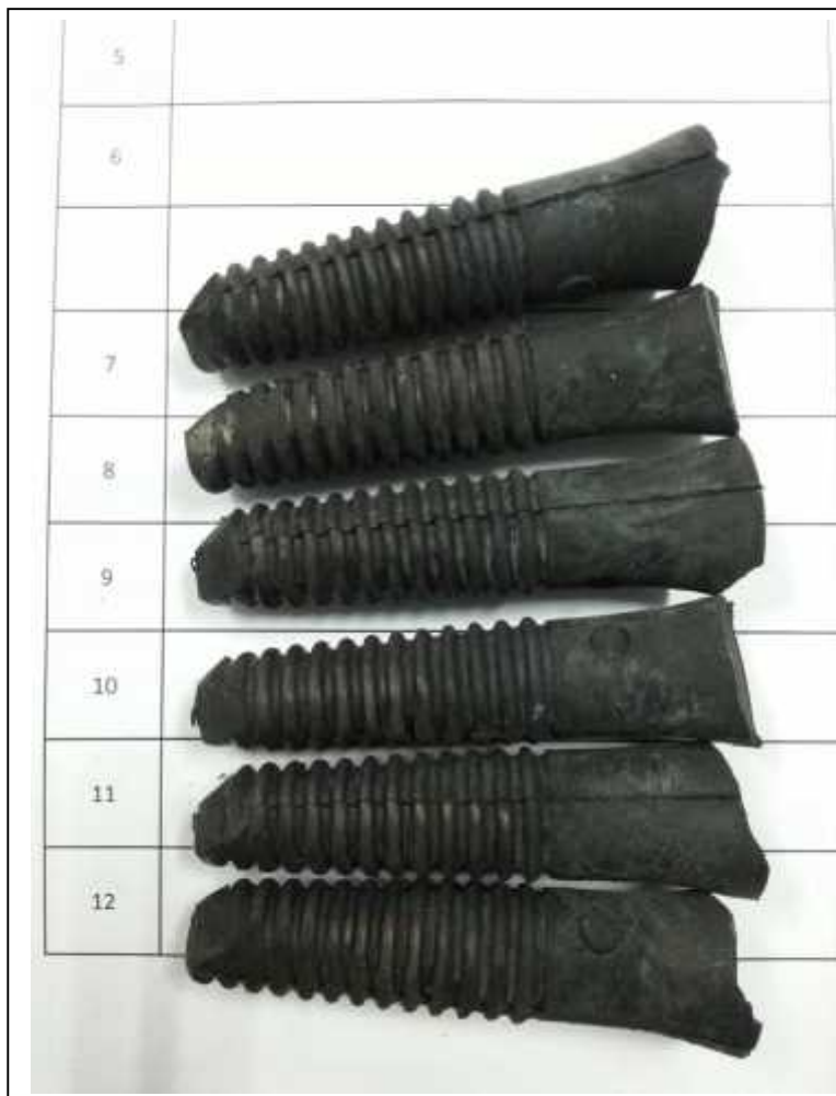
รูปที่ 47 ยางถอนขนไก่ DURAM หลังการทดสอบ (ต่อ)
