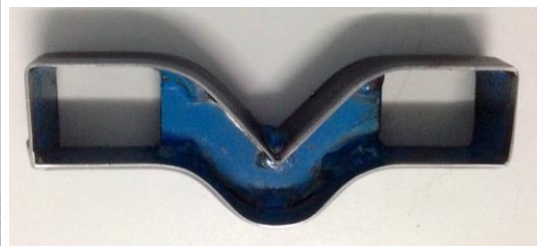
รูปที่ 23 ขนาดและมีตัดตัวอย่างการทดสอบความแข็งแรงฉีกขาด (Tear strength) ตามมาตรฐาน ASTM D624 Type C
