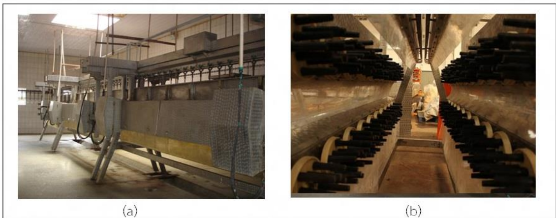
รูปที่ 4 (a) เครื่องถอนขนไก่ในสายการผลิตต่อเนื่อง (b) ยางถอนขนไก่ติดตั้งในเครื่องถอนขนไก่
