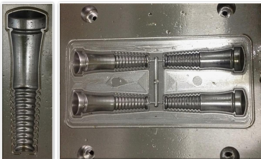
รูปที่ 45 แม่พิมพ์ฉีดยางถนนทนไฟตามรูปแบบใหม่จากโครงการย่อยที่ 2
