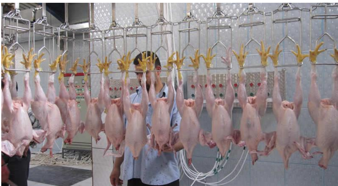
รูปที่ 5 ไก่บนสายการผลิตต่อเนื่อง ภายหลังการผ่านเครื่องถอนขนอัตโนมัติ
