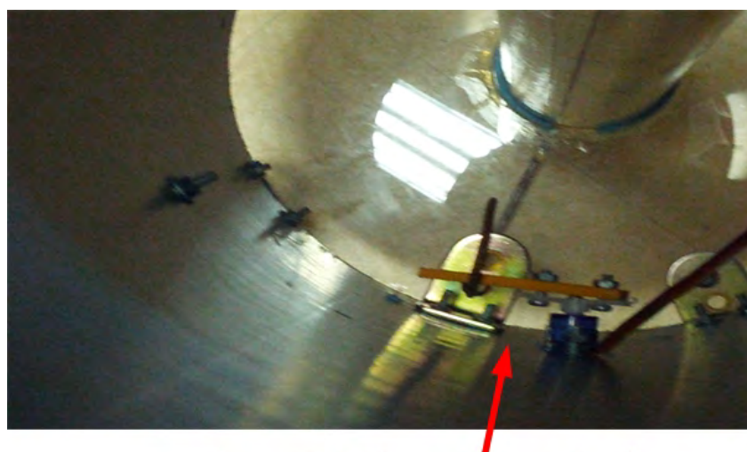
รูปที่ 4.16 ตำแหน่งการทำงานของเซอร์โวมอเตอร์ในการควบคุมการปล่อยน้ำ
