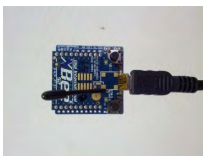
รูปที่ 4.12 การติดต่อกันระหว่างคอมพิวเตอร์และ XBee
