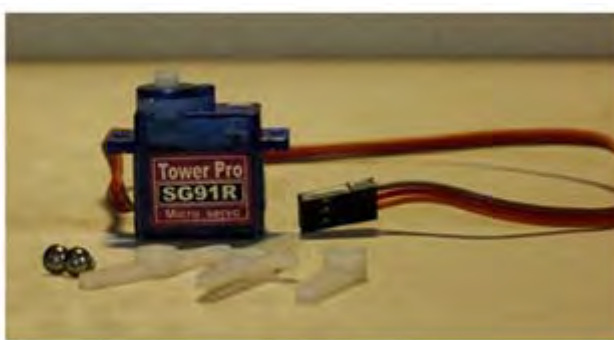
รูปที่ 2.16 เซอร์โวมอเตอร์ขนาด 9 กรัฟที่ใช้ในการทำงาน
