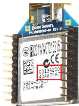
รูปที่ 3.6 หมายเลขประจำตัวของอุปกรณ์ ZigBee ในแต่ละตัว
