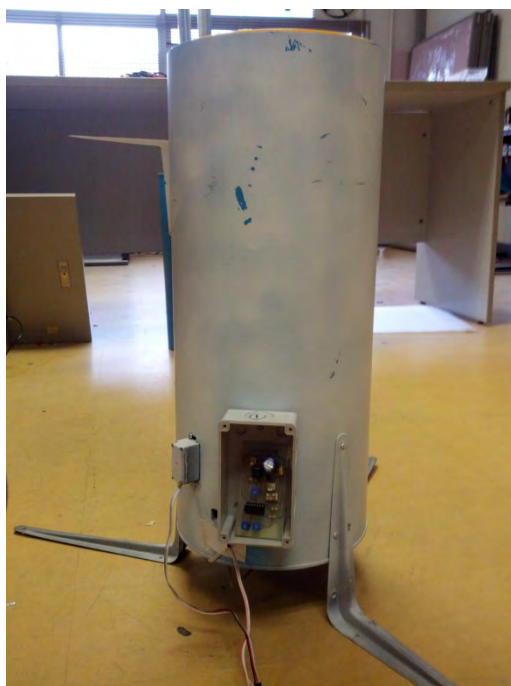
รูปที่ 4.2 เครื่องวัดปริมาณน้ำฝนที่ประกอบอยู่ในท่อพีวีซีขนาดเส้นผ่านศูนย์กลาง 0.203 เมตร
