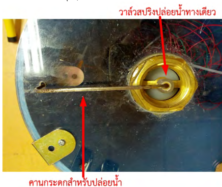
รูปที่ 4.15 ตำแหน่งของคานกระดกเพื่อไปกดวาล์วปล่อยน้ำทิ้งทางเดียว
