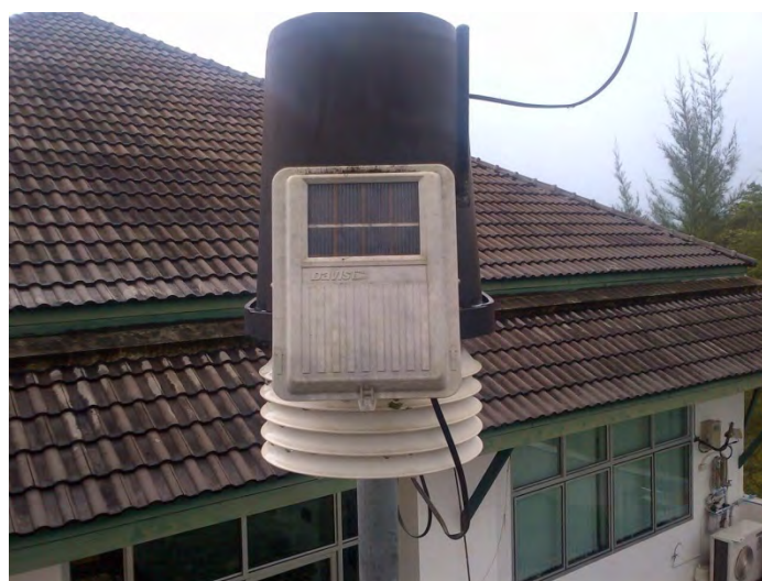
รูปที่ 4.18 เครื่องวัดน้ำฝนและสภาพอากาศ Davis 6152 Vantage Pro2 ที่ทำการเปรียบเทียบ
