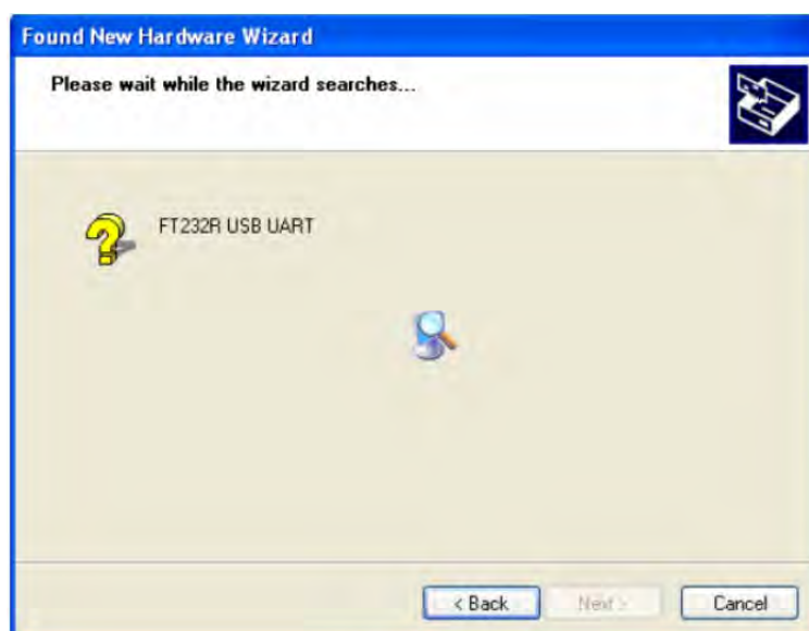
รูปที่ ฉ.3 การค้นหาและติดตั้ง Driver ให้กับอุปกรณ์
