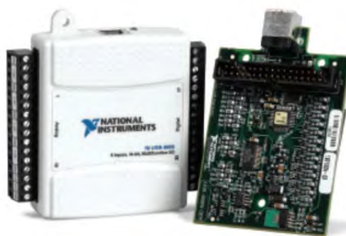
รูปที่ 2.19 NI USB-6008 ที่ใช้ในการทดลอง
