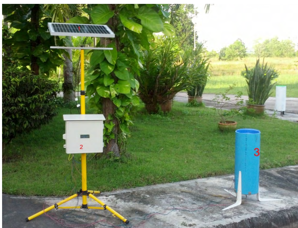
รูปที่ 4.23 เครื่องมือวัดปริมาณน้ำฝนอัตโนมัติที่นำไปใช้งาน จากผลการออกแบบต่างๆ ทำให้ได้เครื่องวัดปริมาณน้ำฝนอัตโนมัติโดยมีราคาต้นทุนดังตารางที่ 4.2
