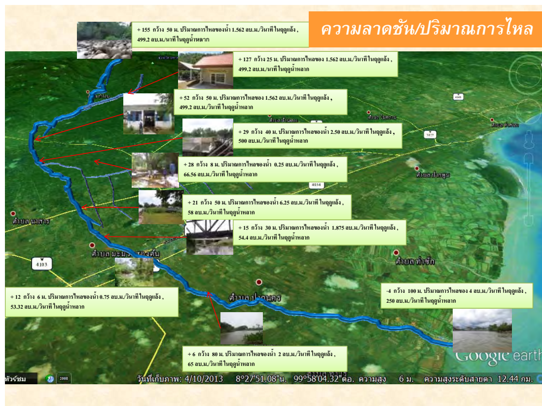
ภาพที่ 4 แสดงความลาดชันและปริมาณการไหลของน้ำ
