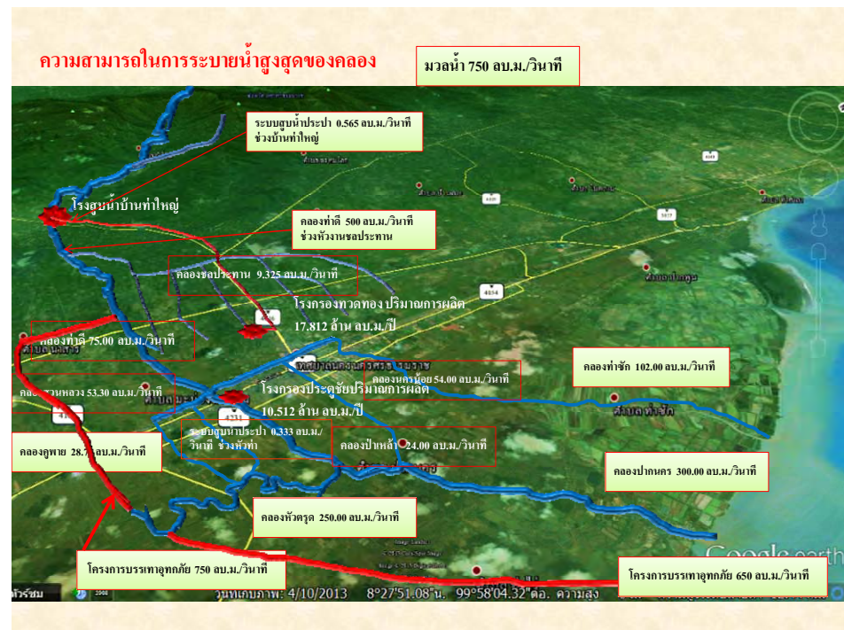
ภาพที่ 5 ความสามารถในการระบายน้ำสูงสุดของคลอง ปริมาณน้ำ 750 ลบ.ม./วินาที
