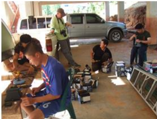
ภาพที่ 3-36 กำลังพลประกอบคอมไฟเข้ากับโครงขาคอมเหล็ก
