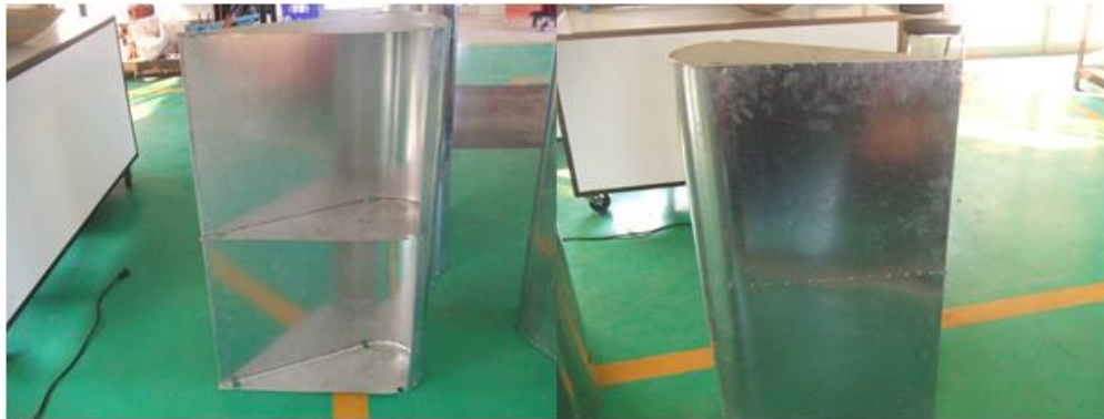
ภาพที่ 3-15 โครงหันลมแนวตั้งรูปหยดน้ำที่ออกแบบเสริมครีบริบเสริมความแข็งแรง
