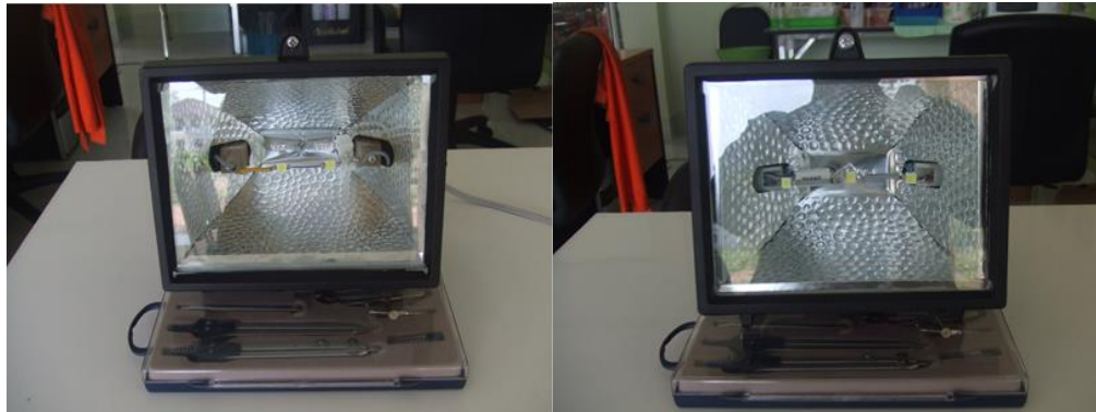
ภาพที่ 3-8 โคมไฟที่ออกแบบโดยใช้หลอด LED ชนิดหลอดเหลือด จำนวน 2 ดวงและจำนวน 3 ดวง
