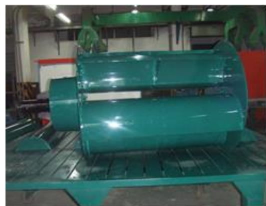
ภาพที่ 3-13 ออกแบบและพัฒนาครีบริบเสริมความแข็งแรงของใบกังหันSAVONIUS ชนิด 5 กليبใบ
