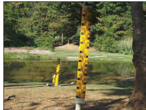
เสาวัดระดับน้ำ ที่แก่งเกาะร้อย
