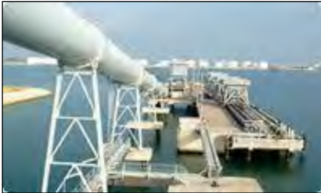
รูปที่ ง-6 การลำเลียงถ่านหินในท่อระบบปิดและในสายพานลำเลียงที่มีหลังคาคลุม
