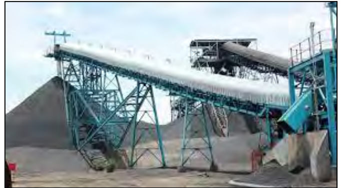
รูปที่ ง-6 การลำเลียงถ่านหินในท่อระบบปิดและในสายพานลำเลียงที่มีหลังคาคลุม
