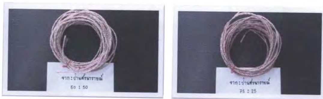
ภาพที่ ๗ เส้นใยผสมเส้นใยจากกับเส้นใยป่านศรนารายณ์ในอัตราส่วน ๕๐ : ๕๐ และ ๗๕ : ๒๕
