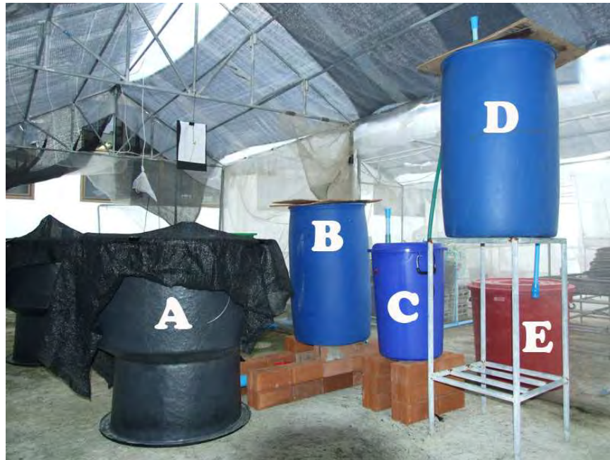
รูปที่ 2-10 การจัดวางถังของระบบปลูกพืชร่วมกับการเลี้ยงปลา เพื่อใช้ปลูกผักกินผลร่วมกับผักสมุนไพร
