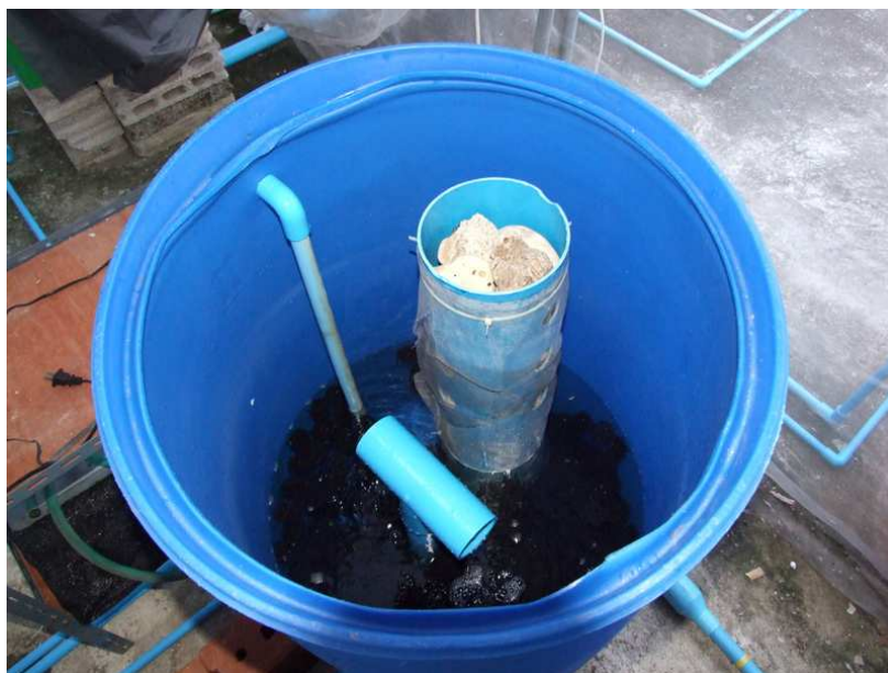
รูปที่ 2-11 โครงสร้างภายในของถังแปลงสภาพสารอาหารและควบคุมความเป็นกรดเป็นด่าง
