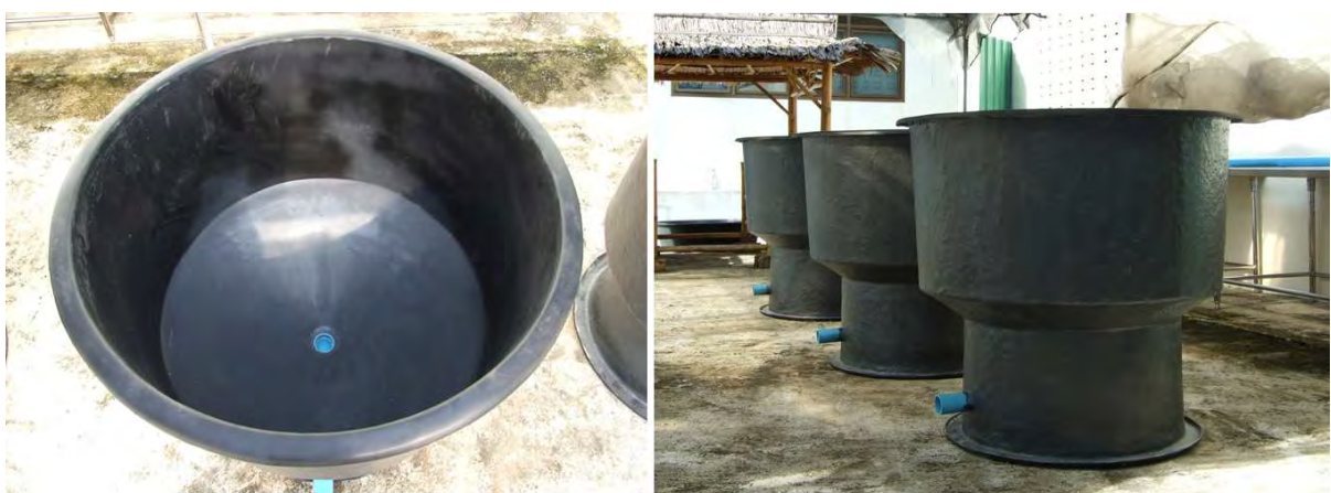
รูปที่ 2-4 ถังเลี้ยงปลาที่ทางโครงการเลือกใช้ มีลักษณะเป็นถังทรงกระบอกก้นกรวย และมีท่อระบายของเสียกลางถัง ปริมาตรถังประมาณ 500 ลิตร
