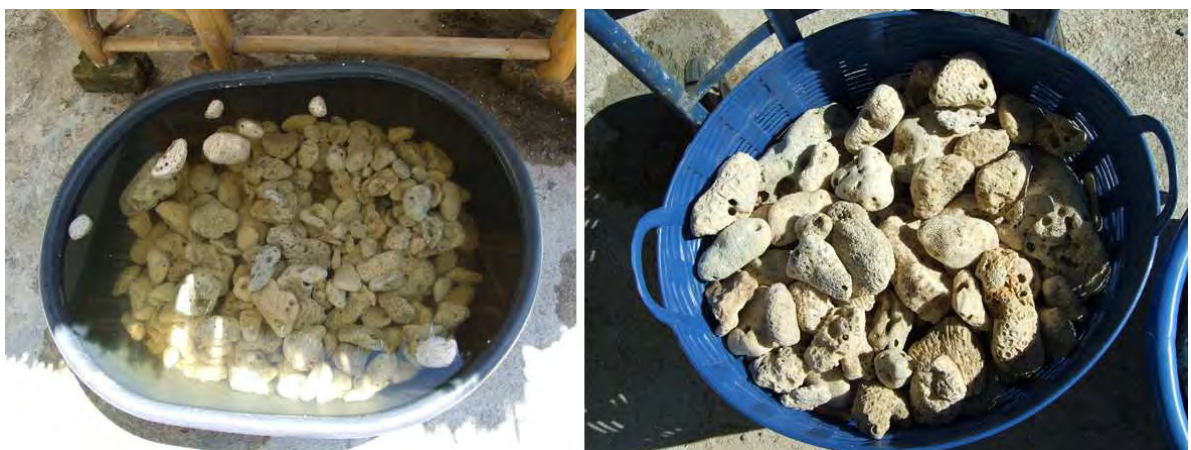
รูปที่ 2-6 ซากปะการังซึ่งผู้วิจัยเดินทางไปเก็บมาจากชายหาดจังหวัดพังงา นำมาแช่น้ำไว้ 1 สัปดาห์ แล้วล้างทำความสะอาด เพื่อใช้เป็นที่อยู่อาศัยของจุลินทรีย์ และปรับความเป็นกรดเป็นด่าง
