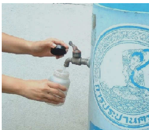
ภาพที่ 2.4 เก็บตัวอย่างน้ำเพื่อตรวจวิเคราะห์ทางกายภาพ เคมี และชีวเคมี
