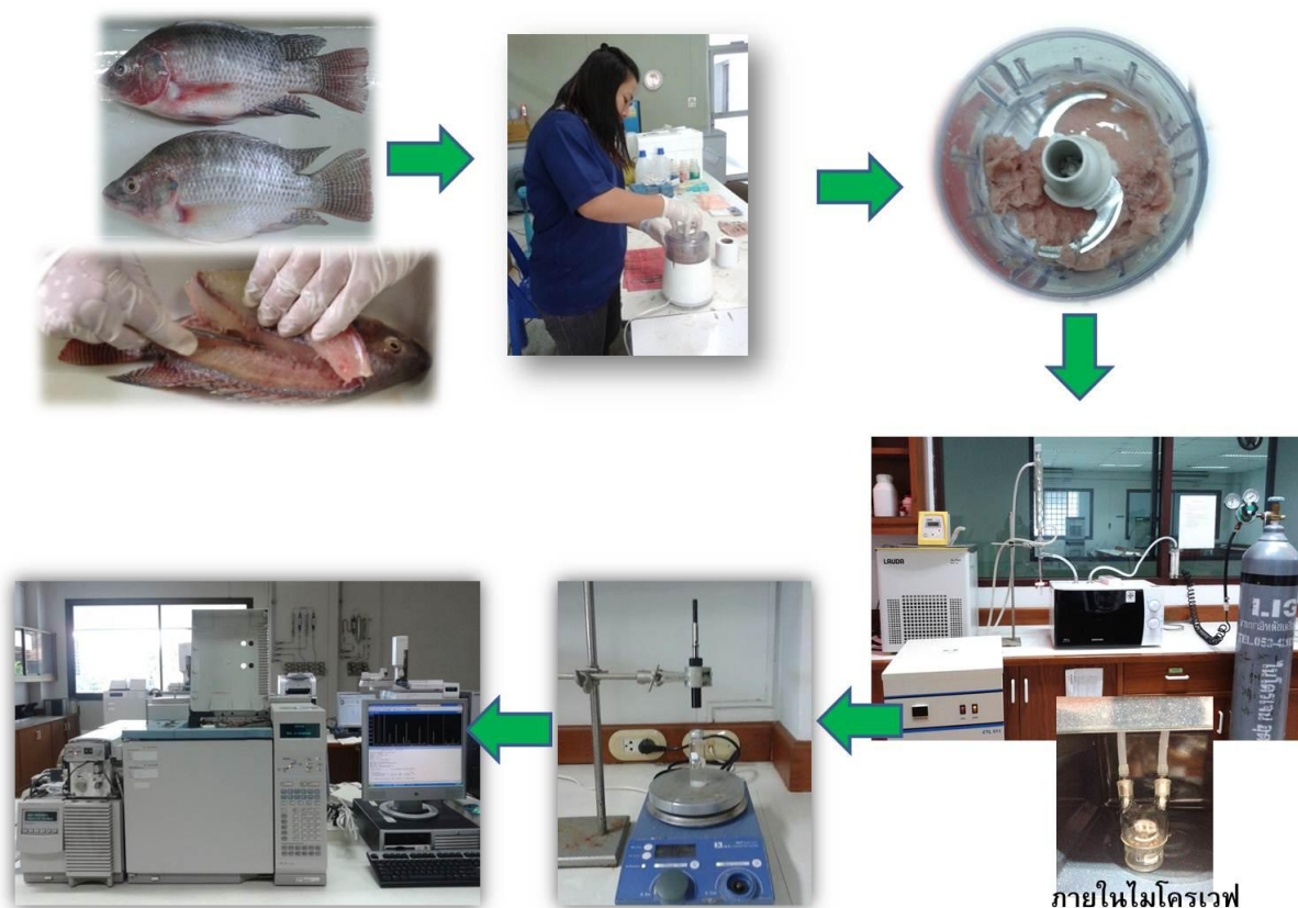
ภาพ 3-11 การวิเคราะห์จีโอสมินและเอ็มไอบีในเนื้อปลา โดยใช้ MD-SPME ร่วมกับ GC/MS
