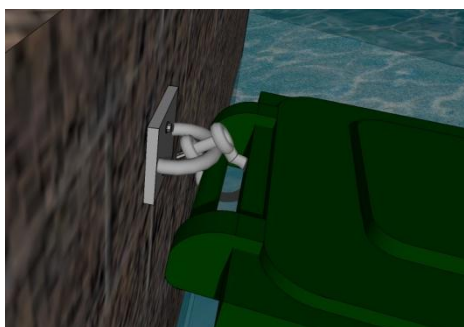
รูปที่ 7-30 ตัวอย่างการทำอุปกรณ์ติดยึดเพื่อป้องกันการล้มหรือสูญหาย
