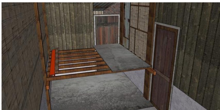
รูปที่ 8-9 การจัดวางส่วนประกอบพื้นที่เมื่อบางส่วนที่วางบนจุดรองรับบนเสาไม้
