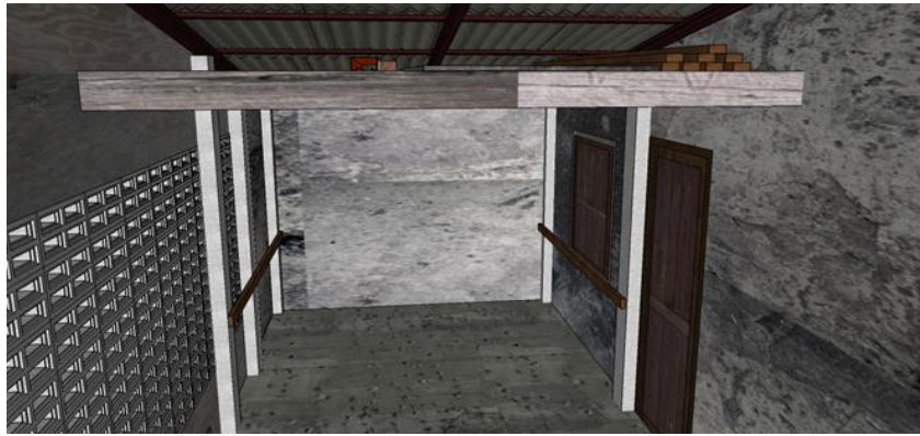
รูปที่ 8-12 การเก็บส่วนประกอบพื้นสำหรับวางบนจุดรองรับบนเสาคอนกรีตในเวลาที่ไม่ท่วม
