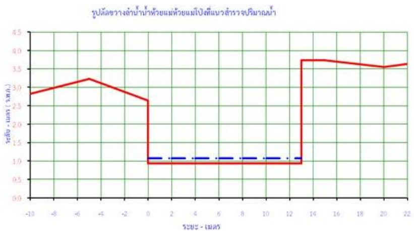
รูปที่ 5-9 รูปตัดขวางลำน้ำแม่โป่ง
