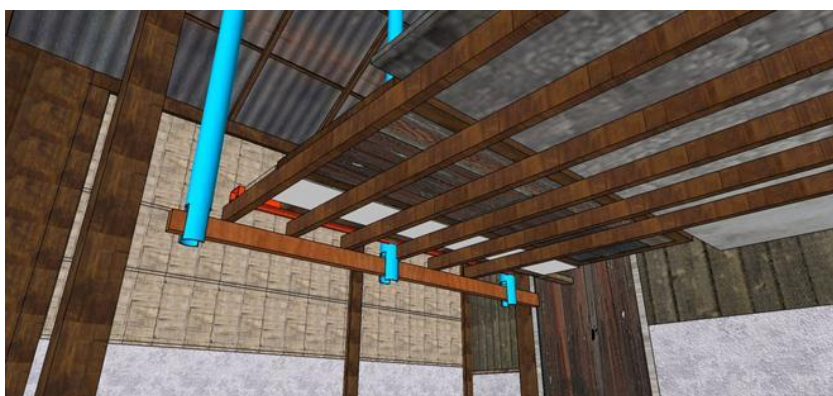
รูปที่ 8-17 ตงพื้นวางพาดบนจุดรองรับแบบที่ยึดแขวนกับจันทัน
