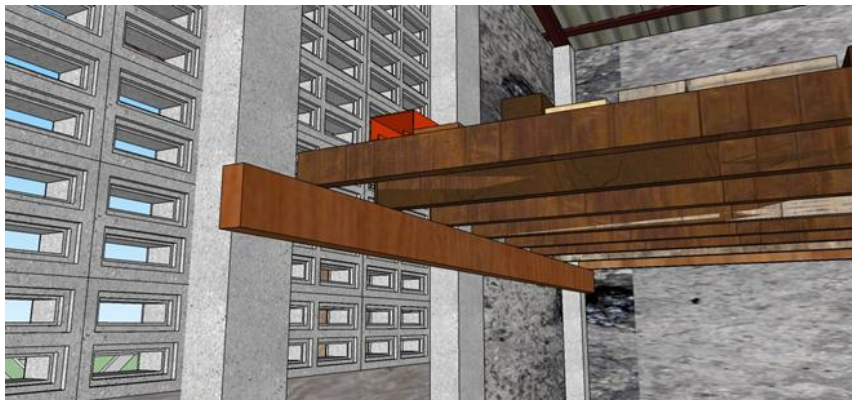
รูปที่ 8-14 การวางตงพื้นบนคานที่ถายน้ำหนักลงเสาคอนกรีต
