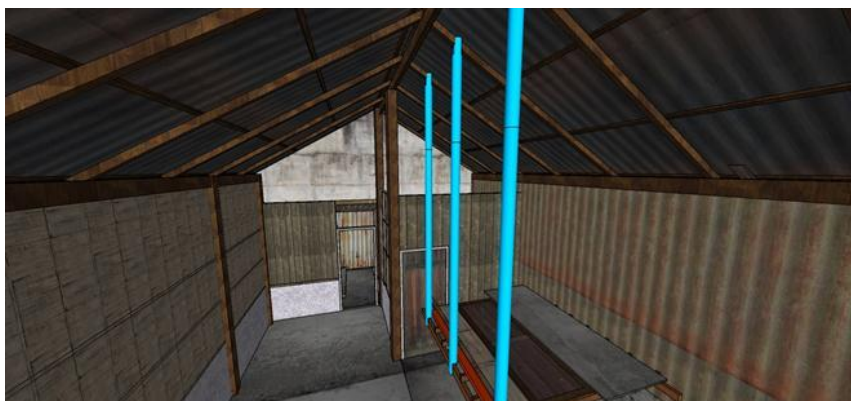
รูปที่ 8-16 การทำจุดรองรับแบบยึดแขวนกับจันทันโดยใช้ท่อพีวีซี
