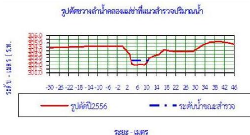
รูปที่ 5-17 รูปตัดขวางคลองแม่ข่ายที่แนวสำรวจปริมาณน้ำ
