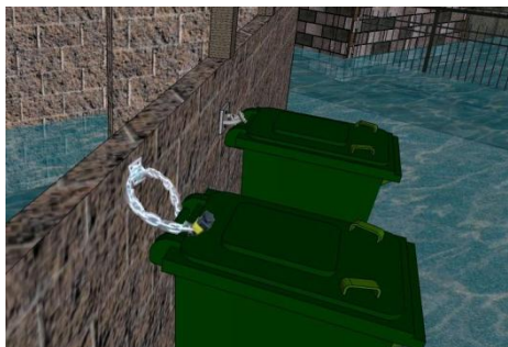
รูปที่ 7-29 ตัวอย่างการทำอุปกรณ์ติดยึดเพื่อป้องกันการล้มหรือสูญหาย
