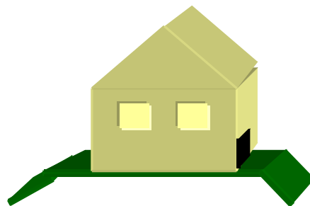
รูปที่ 2-5 ถมดินเพื่อสร้างบ้าน ที่มา: FEMA, 2014
