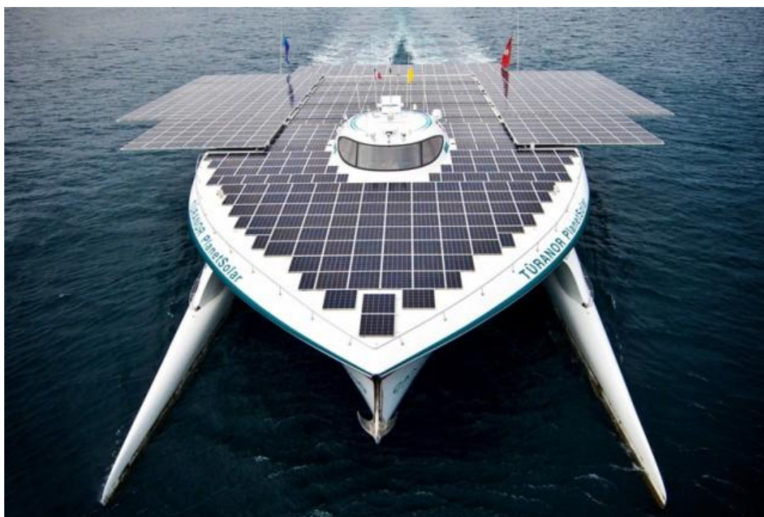
รูปที่ 8 เรือพลังแสงอาทิตย์ PlanetSolar เรือพลังแสงอาทิตย์แสงอาทิตย์ลำแรกที่เดินทางรอบโลก... (จาก. http://www.fubiz.net/en/2012/07/25/planet-solar-boat/ ..)
