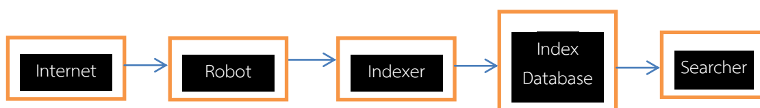
รูปที่ 2.3: โครงสร้างการทำงานของ Web Search Engine
