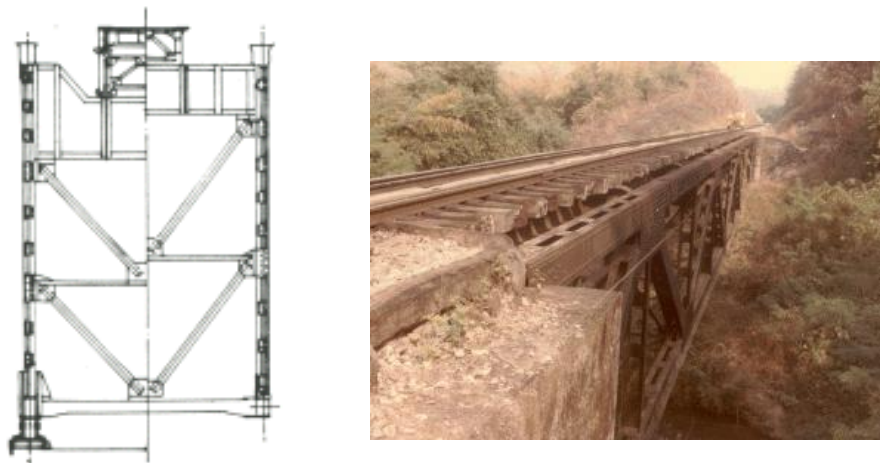
รูปที่ 3.1-19 สะพาน Deck Truss
