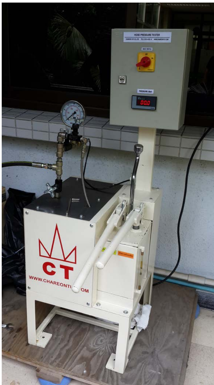
รูปที่ 2.1 เครื่องมือทดสอบความทนความดันพิสูจน์และความทนความดันระเบิด
