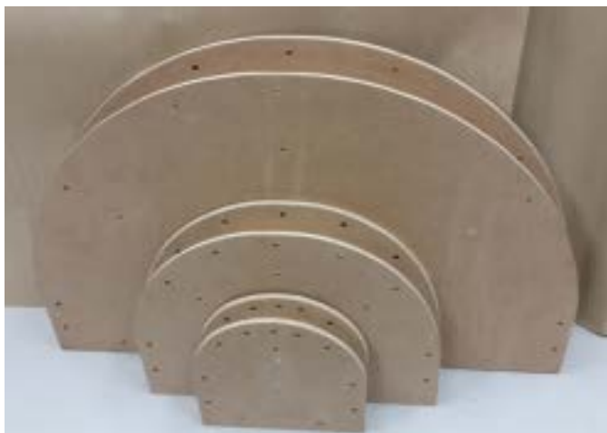
รูปที่ 2.4 อุปกรณ์ประกอบสำหรับทดสอบความสามารถในการตัดโค้งที่อุณหภูมิต่ำของท่อยาง
