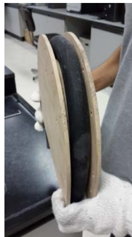
รูปที่ 2.4 อุปกรณ์ประกอบสำหรับทดสอบความสามารถในการตัดโค้งที่อุณหภูมิต่ำของท่อยาง
