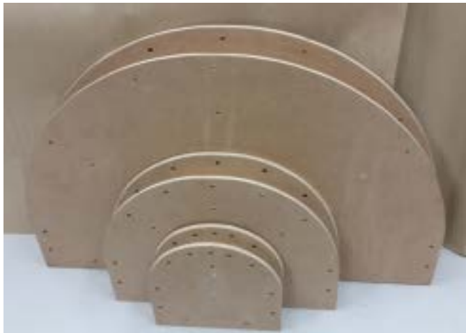
รูปที่ 2.4 อุปกรณ์ประกอบสำหรับทดสอบความสามารถในการดัดโค้งที่อุณหภูมิต่ำของท่อยาง
