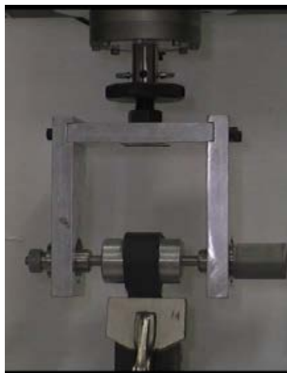
รูปที่ 2.2 อุปกรณ์ประกอบสำหรับทดสอบแรงยึดติดระหว่างยางกับวัสดุเสริมแรง
