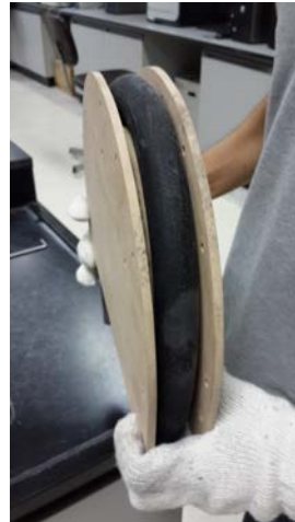
รูปที่ 2.4 อุปกรณ์ประกอบสำหรับทดสอบความสามารถในการดัดโค้งที่อุณหภูมิต่ำของท่อยาง
