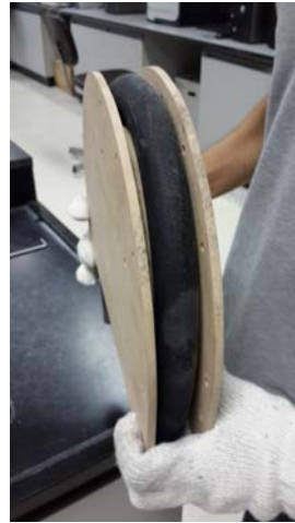
รูปที่ 2.4 อุปกรณ์ประกอบสำหรับทดสอบความสามารถในการตัดโค้งที่อุณหภูมิต่ำของท่อยาง
