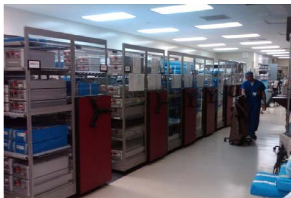
ภาพที่ 2.11 Mobile Cabinet ใช้สำหรับจัดเก็บเวชภัณฑ์ที่ไม่ค่อยได้ใช้งาน เพื่อการประหยัดพื้นที่ ที่มา : http://www.spacesaver.com
