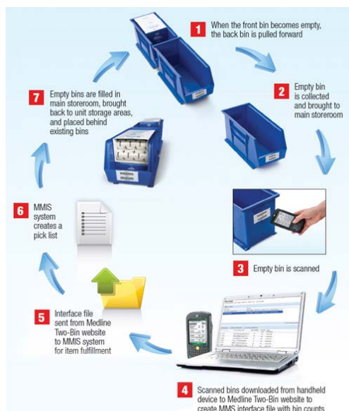
ภาพที่ 2.12 การใช้ระบบTwo-bin system สำหรับเวชภัณฑ์ประเภท Unit Picking ช่วยลดการขาดเวชภัณฑ์ในกรณีมีการใช้เป็นปริมาณมาก หรือเวชภัณฑ์อยู่ระหว่างการเติม
