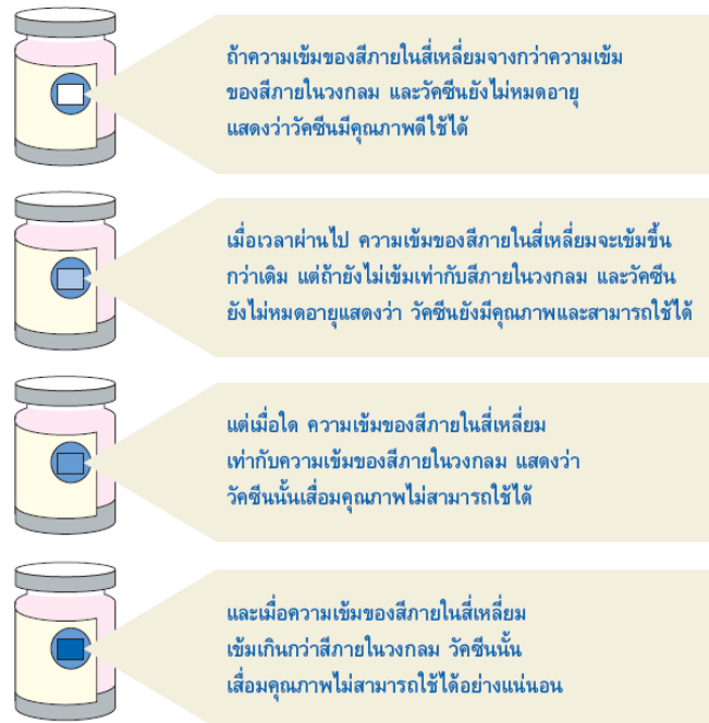
ภาพที่ 6 การอ่านค่า Vaccine Vial Monitor (ที่มา: กองชีววัตถุ, 2552)
