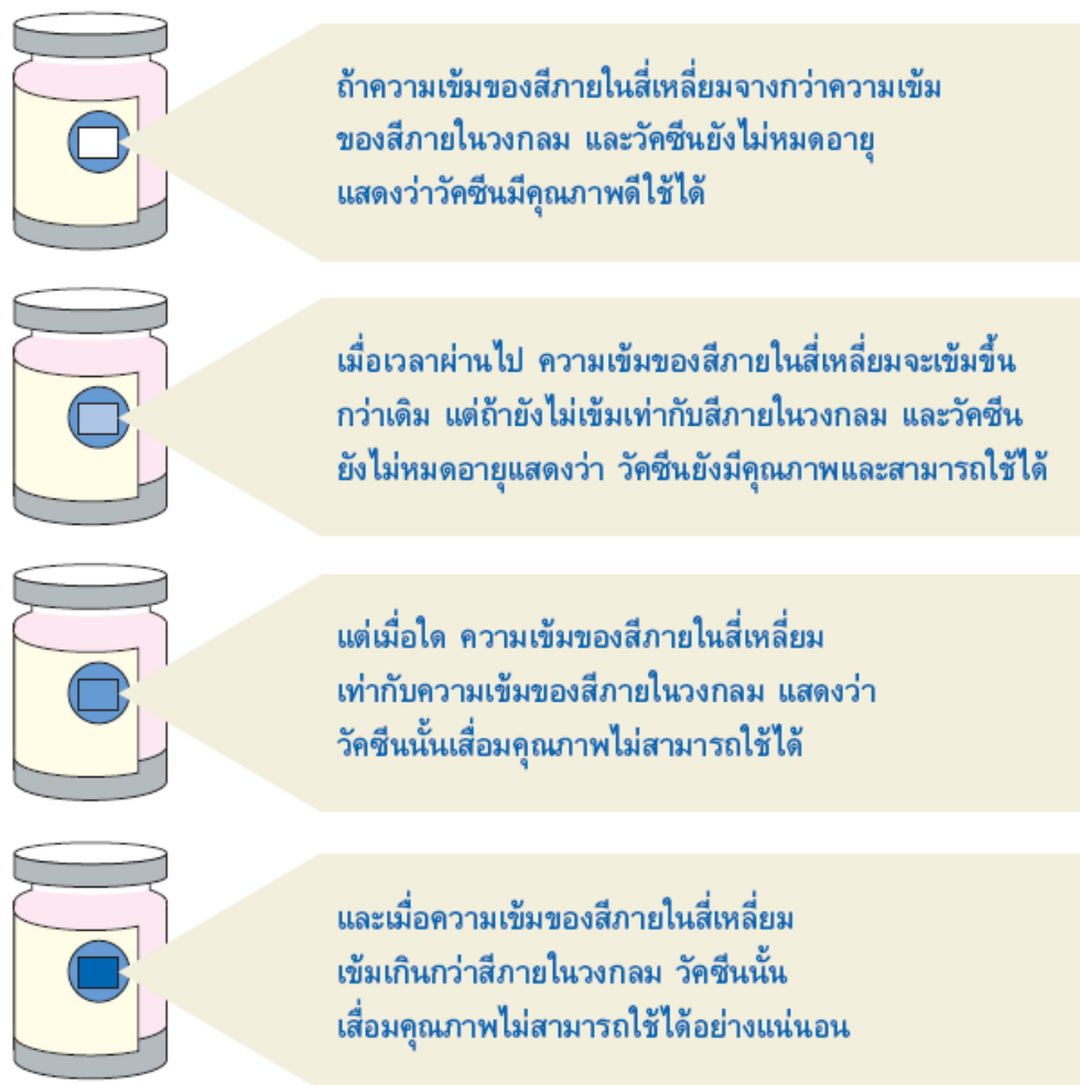
ภาพที่ 2.6 การอ่านค่า Vaccine Vial Monitor
