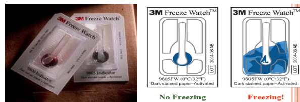
ภาพที่ 12 ลักษณะ Freeze Watch และการอ่านผล (ที่มา: สถาบันวัคซีน, 2555)
