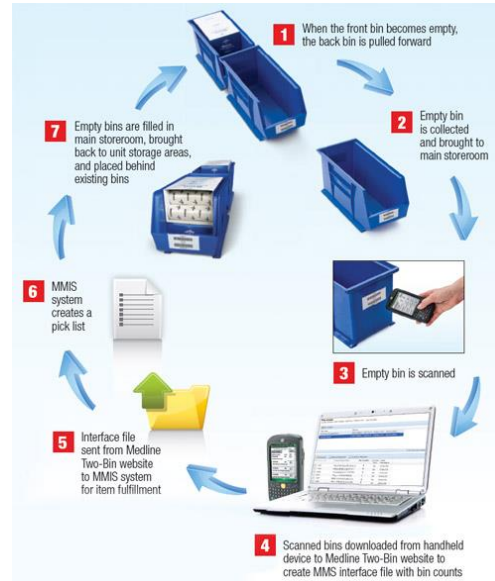
รูปที่ 2.22 การใช้ระบบTwo-bin system สำหรับเวชภัณฑ์ประเภท Unit Picking ช่วยลดการขาดเวชภัณฑ์ ในกรณีมีการใช้เป็นปริมาณมาก หรือเวชภัณฑ์อยู่ระหว่างรอการเติม ที่มา : http://www.medline.com/solutions/IDNs/two-bin-point-of-use-system
