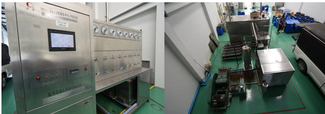
ภาพที่ 1.4 เครื่องสกัดสารโดยใช้เทคนิค sc\text{-CO}_2 ในระดับกึ่งอุตสาหกรรม ขนาด 24 ลิตร
