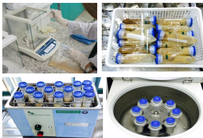
รูปที่ 18 การสกัดตัวอย่างสำหรับการวิเคราะห์ยาปฏิชีวนะ
