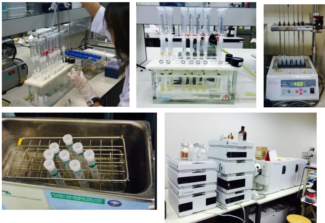
รูปที่ 21 การทำให้บริสุทธิ์สำหรับการวิเคราะห์สารเร่งเนื้อแดง
