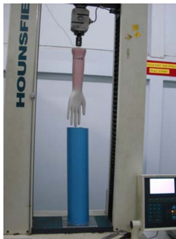
รูปที่ 3.2 การจุ่มแบบขึ้นรูปด้วยความเร็ว 300 มิลลิเมตรต่อนาที
