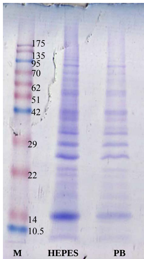
ภาพที่ 8 แสดงการวิเคราะห์โปรตีนด้วยเทคนิค SDS-PAGE จากแผ่นฟิล์มยางที่ถูกสกัดด้วย HEPES และ Phosphate buffer
