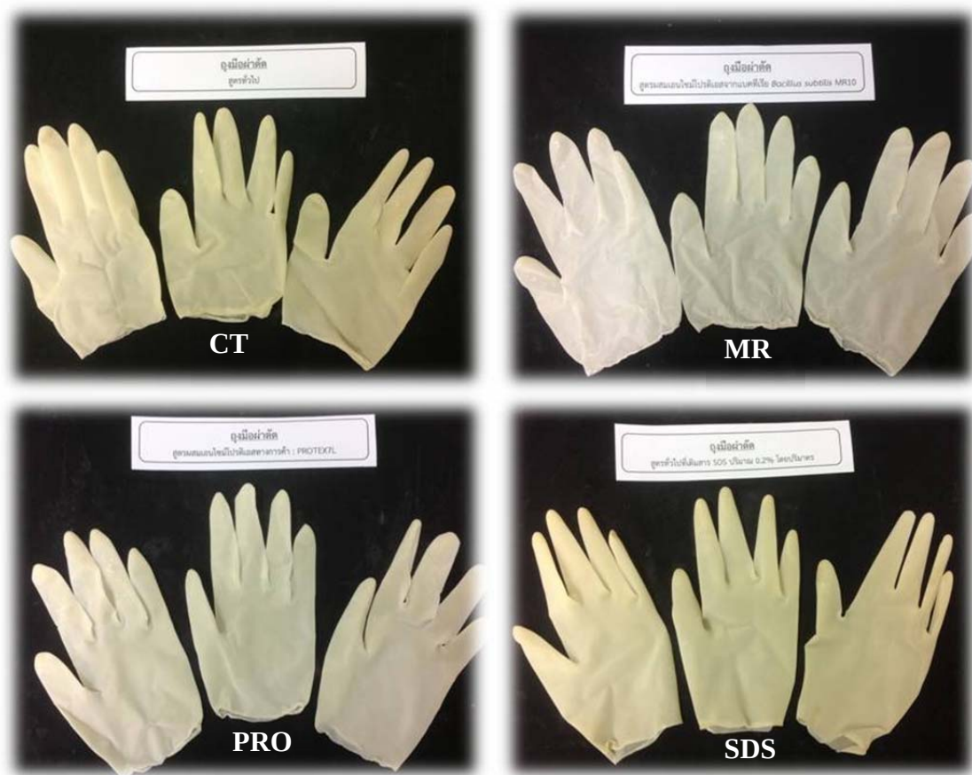
ภาพที่ 9 แสดงลักษณะของถุงมือที่ผลิตได้ด้วยสูตรต่างๆ
