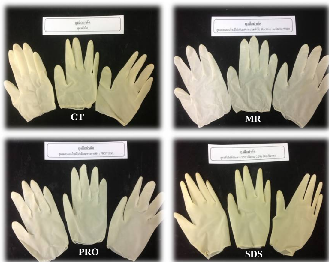
ภาพที่ 12 แสดงลักษณะของถุงมือที่ผลิตได้ด้วยสูตรต่างๆ
