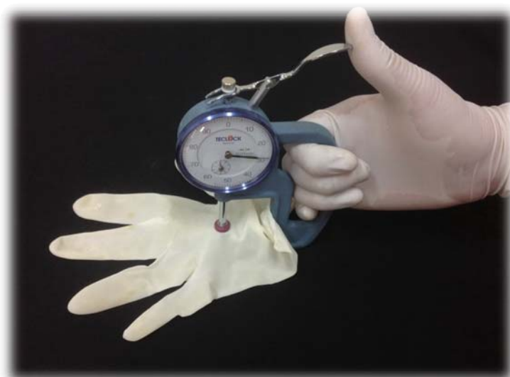
ภาพที่ 13 แสดงการวัดความหนาของถุงมือยางที่ผลิตได้
