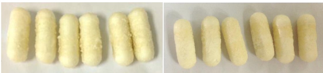
รูป 3 ลักษณะภายนอกของเปลือก hard gelatin capsule ที่เคลือบด้วยน้ำยางที่มีความเข้มข้นของเนื้อยาง 30% ที่เติม camphor 200phr ก่อนนำไปอบที่ 50^\circ\text{C} เวลา 2 ชั่วโมง และเปลือก hard gelatin capsule ที่เคลือบด้วยน้ำยางเข้มข้นที่เติม camphor 200 phr หลังนำไปอบที่ 50^\circ\text{C} เวลา 2 ชั่วโมง (ซ้ายไปขวา)
