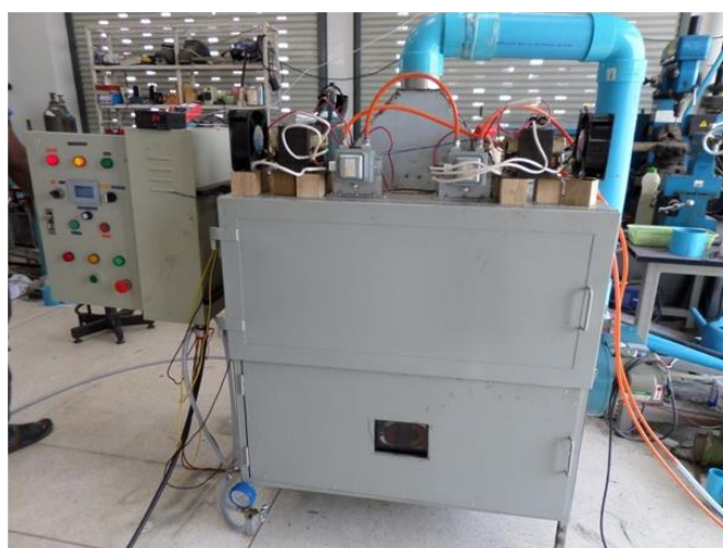
รูปที่4.1ตู้อบไมโครเวฟร่วมกับลมร้อนจากInfrared heater เพื่อการศึกษาพฤติกรรมการอบแห้ง ยาง (ก)ส่วนประกอบของตู้อบ (ข)ลักษณะของตู้อบ
