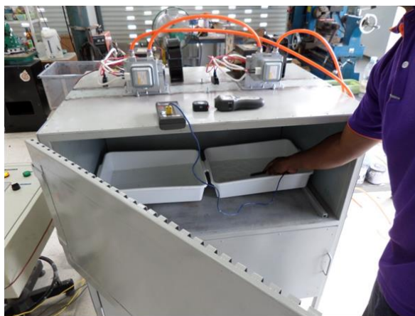
รูปที่4.2 แสดงการวางภาชนะใส่น้ำเพื่อเป็นโหลดในการวัดกำลังของคลื่นไมโครเวฟ
