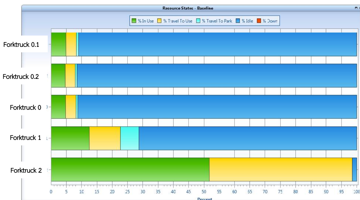
รูปที่ 5.64 ทรัพยากรของแบบจำลองคลังวัตถุดิบในโรงงานผลิตอาหารกุ้งเมื่อเพิ่มความถี่ในการรับวัตถุดิบ โดยมีปริมาณในการรับวัตถุดิบน้อยลง
