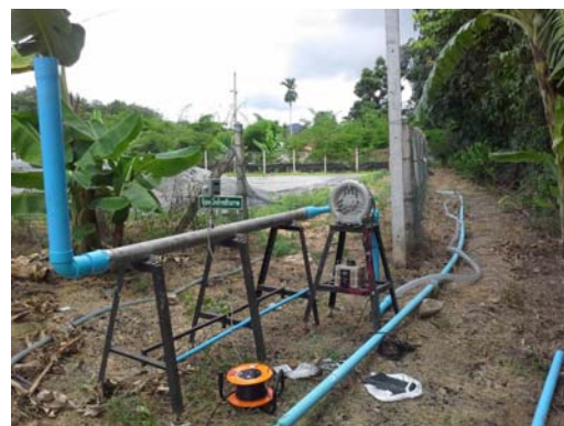
รูปที่ 4-21 การติดตั้งและตรวจวัดปริมาณก๊าซชีวภาพด้วยเครื่องวัดอัตราการไหลและอุปกรณ์ระบบท่อชุดก๊าซชีวภาพ ณ บ่อหมักก๊าซชีวภาพ สหกรณ์ฯ บ้านเก่าร้าง
