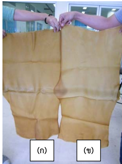
รูป 4-24 (ก) ยางแผ่นรมควันที่ใช้ไม้พินเป็นเชื้อเพลิง (ข) ยางแผ่นที่รมควันที่ใช้ไม้พินร่วมกับก๊าซชีวภาพเป็นเชื้อเพลิง
