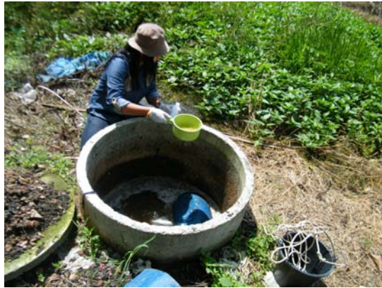
รูปที่ 4-9 จุดเก็บตัวอย่างน้ำเสียจากกระบวนการผลิตยางแผ่นรมควัน (บ่อรวมน้ำเสีย)
