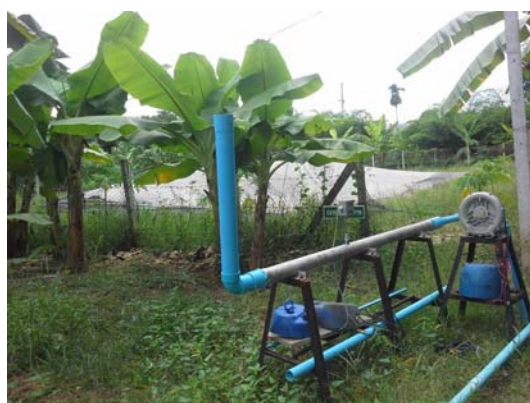
รูปที่ 4-37 ตรวจวัดปริมาณก๊าซชีวภาพด้วยเครื่องวัดอัตราการไหลและอุปกรณ์ระบบท่อดูดก๊าซชีวภาพในระหว่างการทดสอบเติมมูลสุกร
