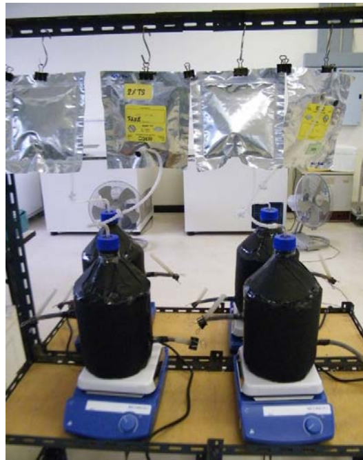
รูปที่ 3-4 ระบบผลิตก๊าซชีวภาพในระดับห้องปฏิบัติการ จำนวน 4 ชุดการทดลอง
