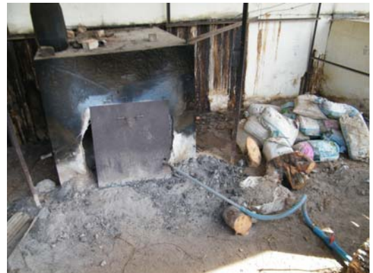
รูปที่ 4-26 ท่อพีวีซีเชื่อมต่อกับท่อเหล็กเข้าเตาไม้ฟืน (ท่อเหล็กยาวประมาณ 1-2 เมตร)
