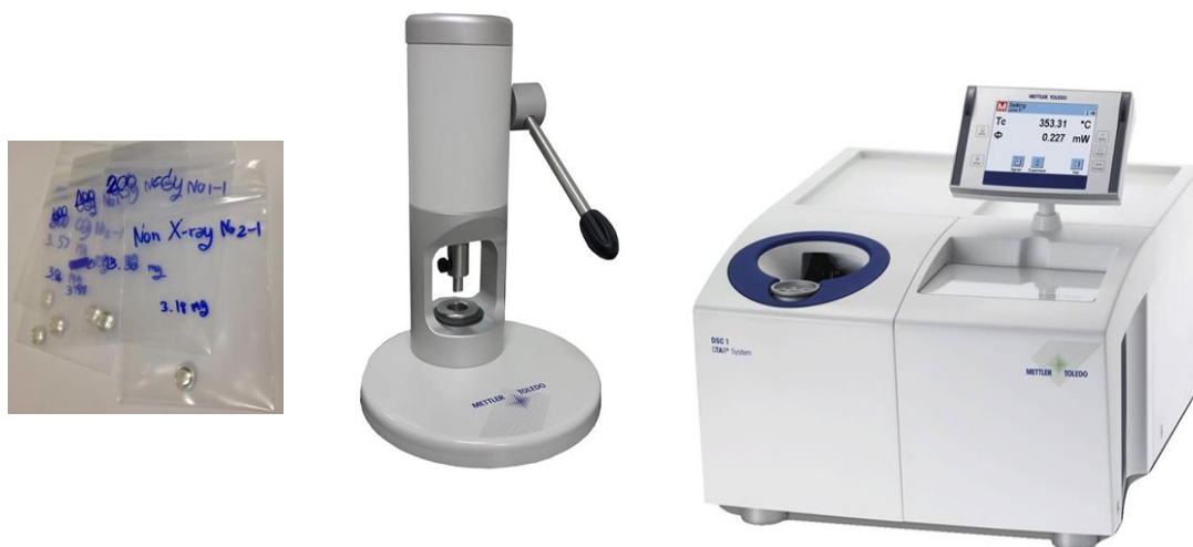
ภาพที่ 22 แสดง Sample crucibles, crucible sealing press and Differential Scanning Calorimetry (DSC)
