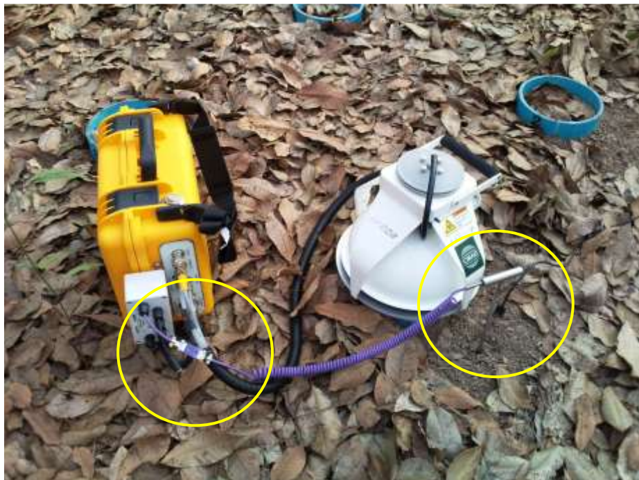
รูปที่ 2-9 อุปกรณ์วัดอุณหภูมิดิน (T handle thermocouple) ซึ่งสามารถเชื่อมต่อกับเครื่องวัดอัตราการหายใจของดินได้
