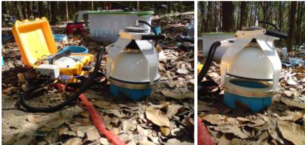
รูปที่ 2-8 เครื่องวัดอัตราการหายใจของดิน (Soil CO 2 Flux System) รุ่น LI-8100 ® (LI-COR, Inc., Ltd., U.S.A.)
