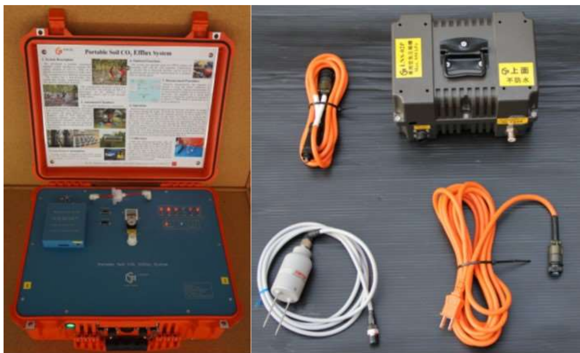
รูปที่ 2-15 เครื่องวัดอัตราการหายใจของดินแบบอัตโนมัติขนาด 2 chamber ที่พัฒนาร่วมกับ National Institute for Environmental Studies แสดงให้เห็นกล่องควบคุม (รูปซ้าย) และอุปกรณ์ประกอบอื่นๆ (รูปขวา)
