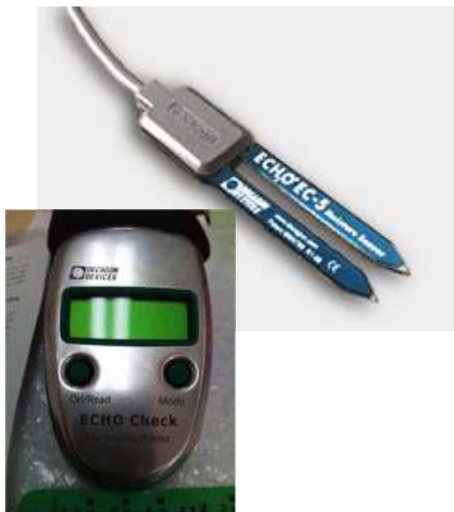
รูปที่ 2-10 อุปกรณ์วัดปริมาณน้ำในดิน (Soil moisture sensor) รุ่น EC-5 (Decagon Devices, Inc.m U.S.A.) ซึ่งอ่านค่าที่วัดได้โดยใช้ ProCheck (Decagon Devices, Inc.m U.S.A.)
