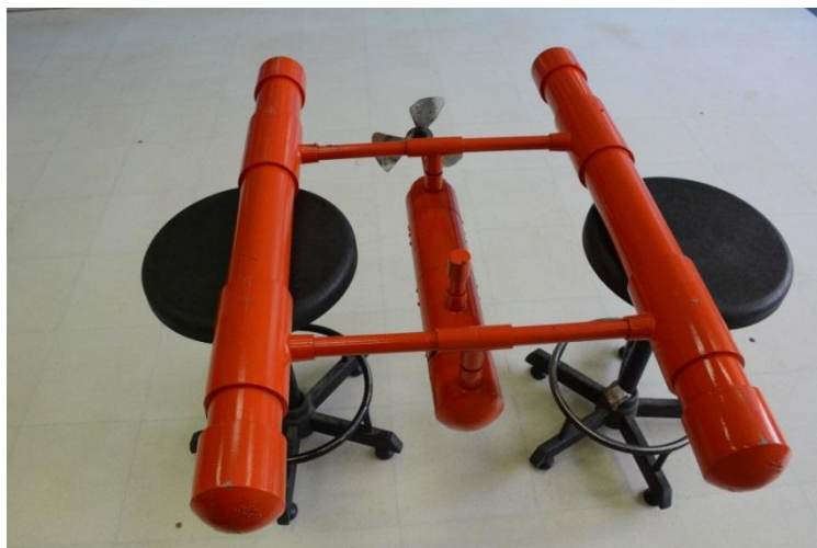
ภาพที่ 27 ท่าวางเครื่องเพื่อวัดความเร็วรอบ
