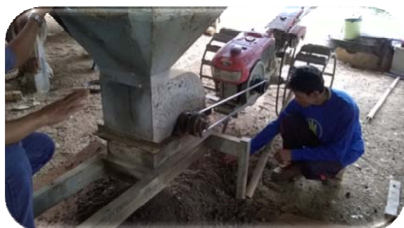
รูปที่ 26 การดัดแปลงเครื่องปั่นปุ๋ยที่มีอยู่เดิม
