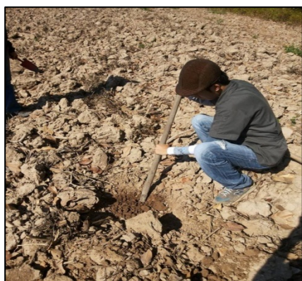
ภาพ 7 การเก็บตัวอย่างดินโดย (ก) ขุดตัวอย่างดินลึกประมาณ 15 cm. และ (ข) ใช้ ซองพรวนดินเก็บตัวอย่างใส่ในถุงพลาสติก
