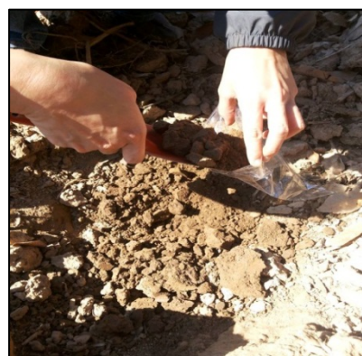
ภาพ 7 การเก็บตัวอย่างดินโดย (ก) ขุดตัวอย่างดินลึกประมาณ 15 cm. และ (ข) ใช้ ซองพรวนดินเก็บตัวอย่างใส่ในถุงพลาสติก
