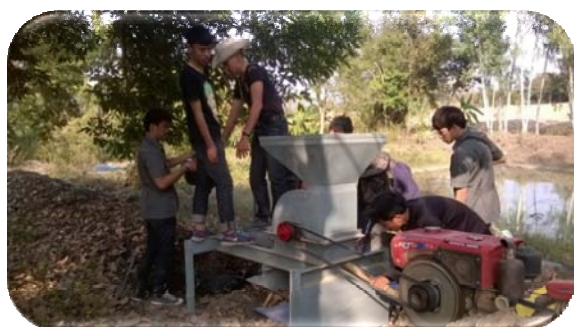
รูปที่ 27 การนำเครื่องปั่นปุ๋ยไปใช้กับปุ๋ยหมักกองที่ 2
