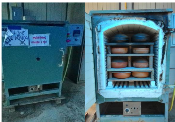
ภาพที่ 2 ส่วนประกอบของเตาเผาไฟฟ้าขนาด 150 \times 90 \times 90\text{ cm}
