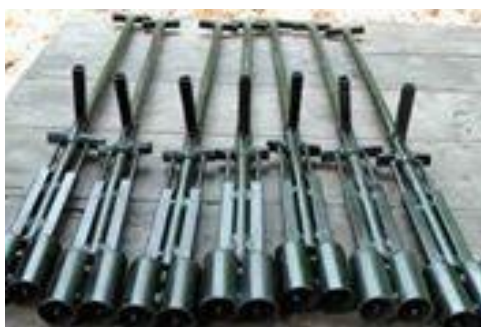
ภาพที่ 2.15 เครื่องอัดถ่านแท่งแบบอัดร้อน
