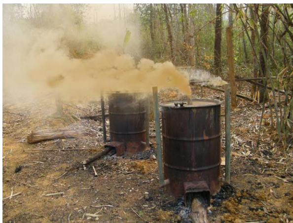
ภาพที่ 3.23 แสดงกระบวนการคายความร้อนจะมีควันสีเหลืองและการระเหยของไอน้ำเกิดขึ้น
