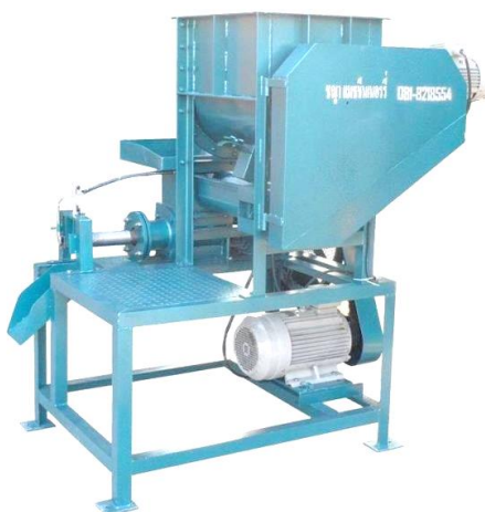
ภาพที่ 2.14 เครื่องอัดถ่านแท่งแบบอัดเย็น
