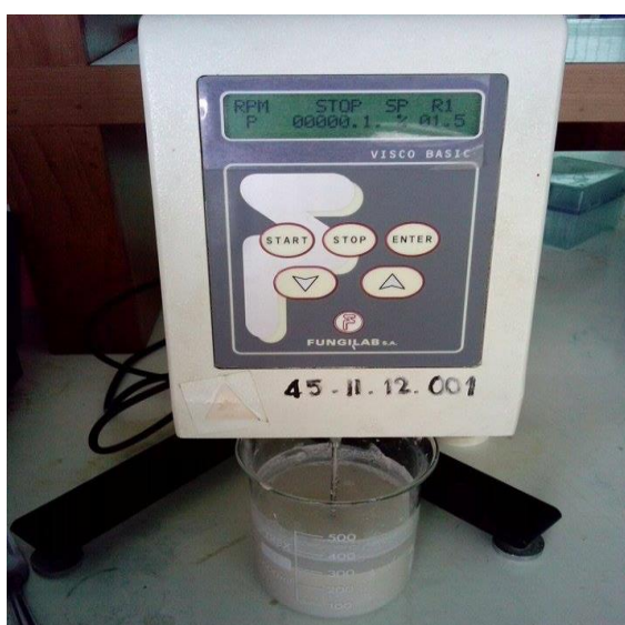
ภาพที่ 3.13 แสดงตัวอย่างการหาค่าความหนืดจากปูนขาว
