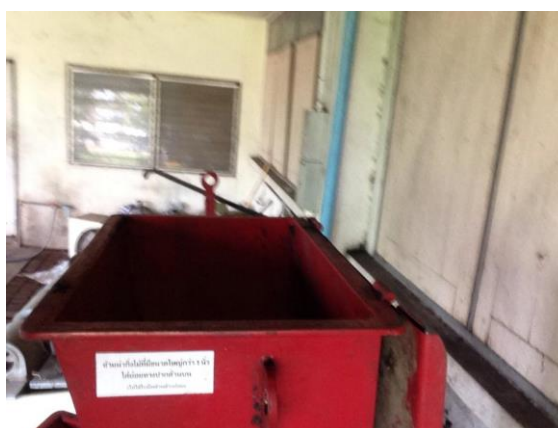
ภาพที่ 3.28 แสดงช่องที่ใช้ใส่ถ่านเพื่อทำการบด
