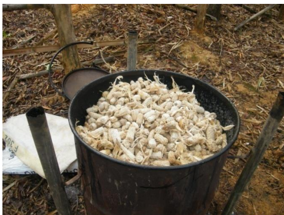
ภาพที่ 3.19 แสดงขั้นตอนการนำซังข้าวโพดมาใส่ในเตาเผา
