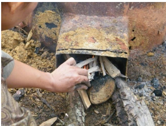
ภาพที่ 3.21 แสดงขั้นตอนการจุดไฟอยู่บริเวณปากของช่องเชื้อเพลิง
