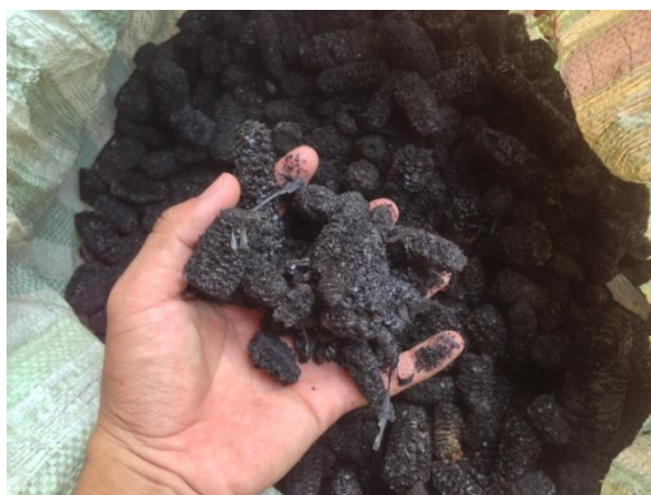
ภาพที่ 3.26 แสดงถ่านจากชังข้าวโพดที่ได้จากการเผาในเตาเผาแบบตั้ง ขนาด 200 ลิตร
