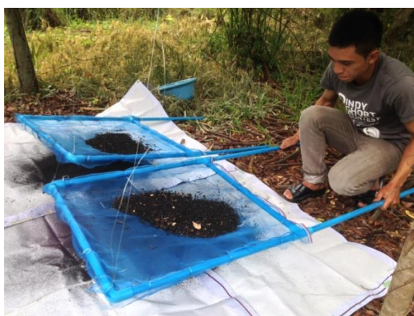
ภาพที่ 3.30 แสดงการล่อนถ่านผ่านไนล่อนตาข่ายขนาด 1.44 ตารางมิลลิเมตร
