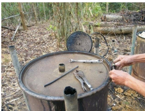
ภาพที่ 3.20 แสดงขั้นตอนการปิดเตาเพื่อเตรียมการเผา
