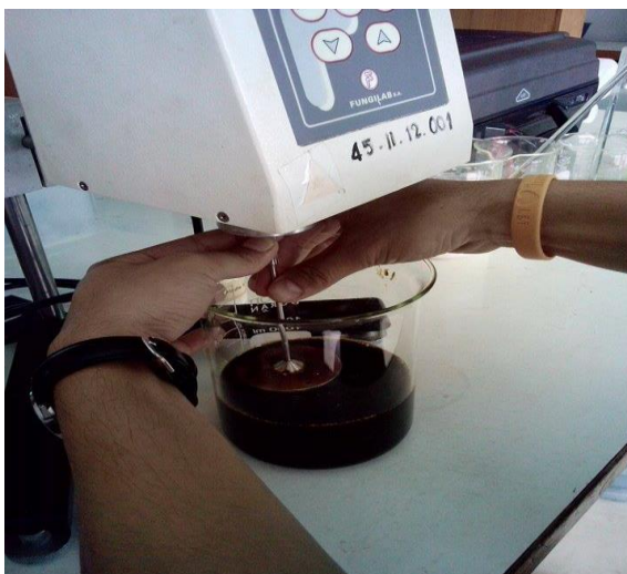
ภาพที่ 3.12 แสดงการต่อหัววัดเข้ากับเครื่อง Brookfield Viscometer
