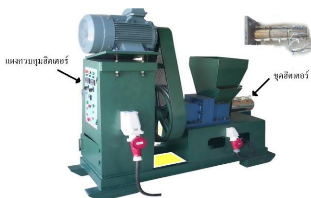
ภาพที่ 2.13 เครื่องอัดถ่านแท่งแบบอัดร้อน
