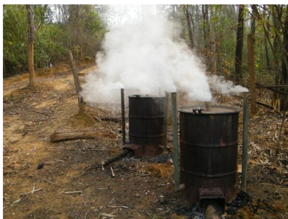
ภาพที่ 3.22 แสดงขั้นตอนการไล่ความชื้น โดยควันที่ออกมาจะมีสีขาว
