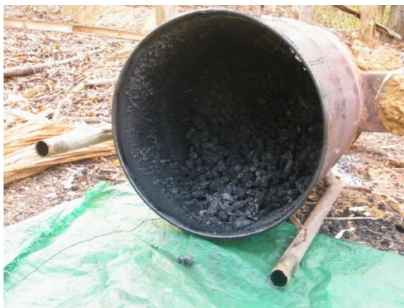
ภาพที่ 3.25 แสดงขั้นตอนการเปิดเตาเป็นกระบวนการลดความร้อนภายในเตา
