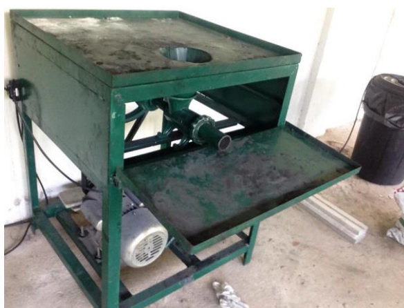
ภาพที่ 3.31 แสดงเครื่องอัดถ่านที่ใช้ในการดำเนินงานวิจัย
