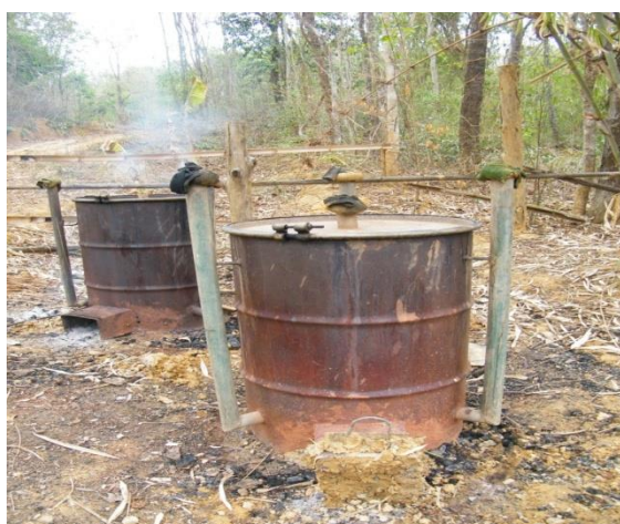
ภาพที่ 3.24 แสดงขั้นตอนการนำผ้ามาปิดปากท่อทั้งสามและปล่องใส่ฟืน
